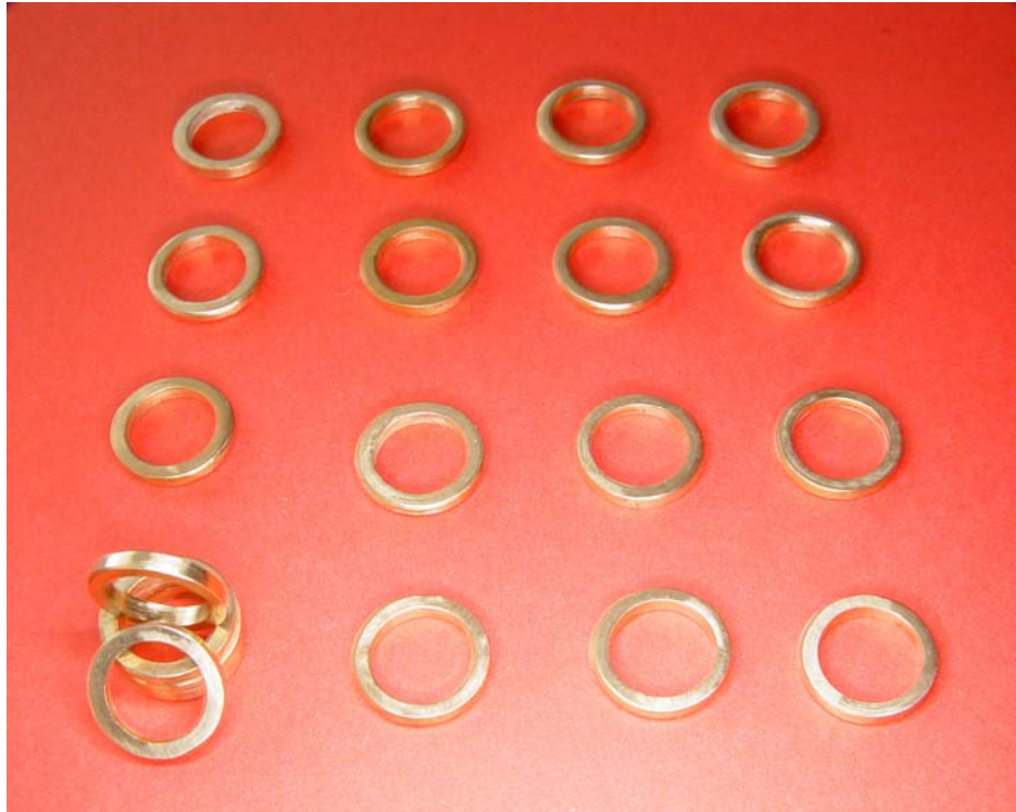
Resim 3.15: İç apı 7,5 mm, yüksekliđi 1,5 mm, iç hacmi 66 mm 3 olan standart metal kalıplar
