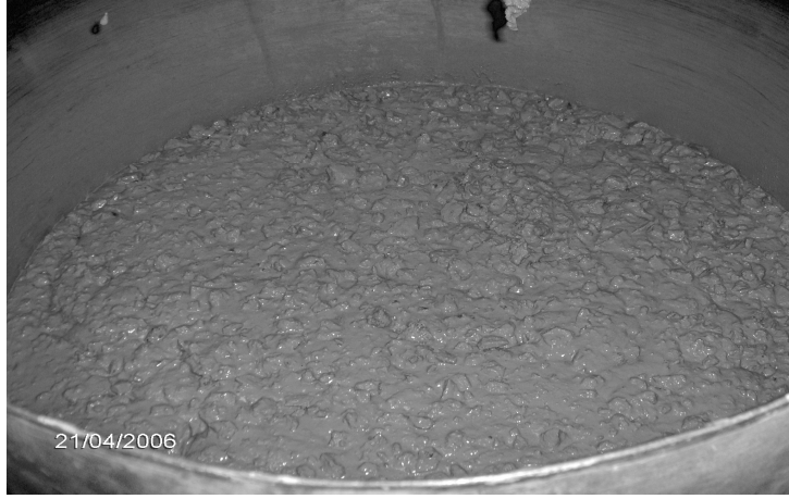
Şekil 2.1: Beton Mikserinde Taze Beton Görünüşü
