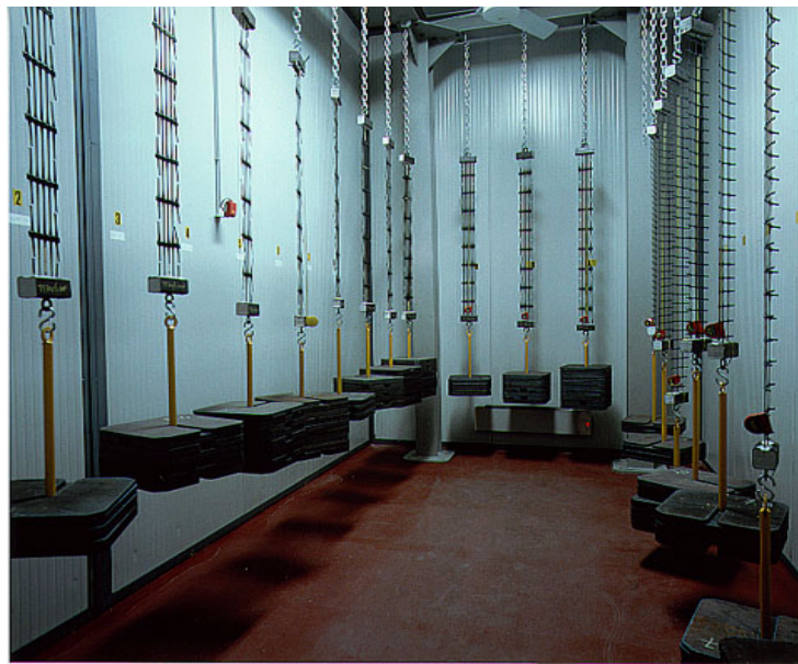
Şekil 3.6 : Sünme testi laboratuvarından bir görüntü Tenax Fabrikası, İtalya [18]
