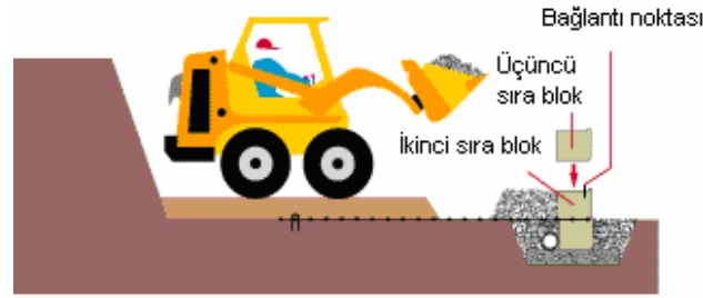
Şekil 3.14 : Geogridli duvarda blok yerleştirilmesi
