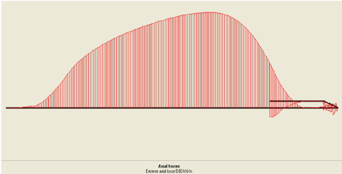
Şekil 6.26 : 2. sıra geogride gelen yükler
