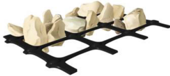
Şekil 3.1 : Zemin – geogrid kenetlenmesi [11]
