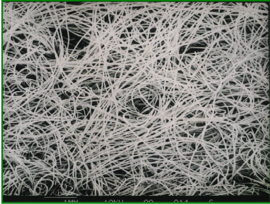
Şekil 2.1 : Örgüsüz geotekstilin mikroskoptaki görünümü
