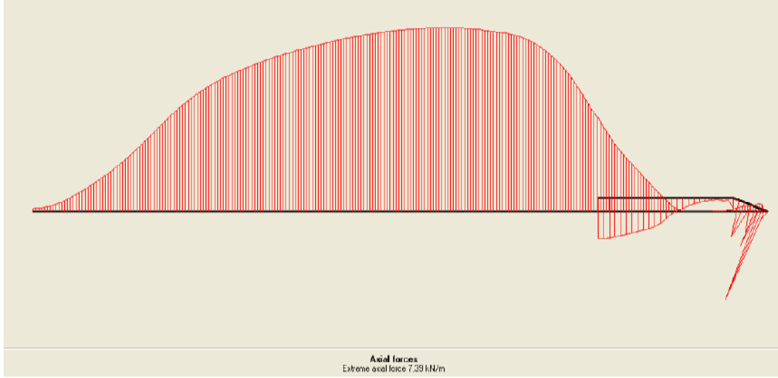
Şekil 6.16 : 3. sıra geogride gelen yükler
