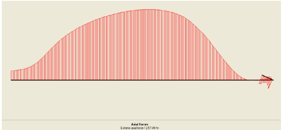
Şekil 6.15 : 2. sıra geogride gelen yükler
