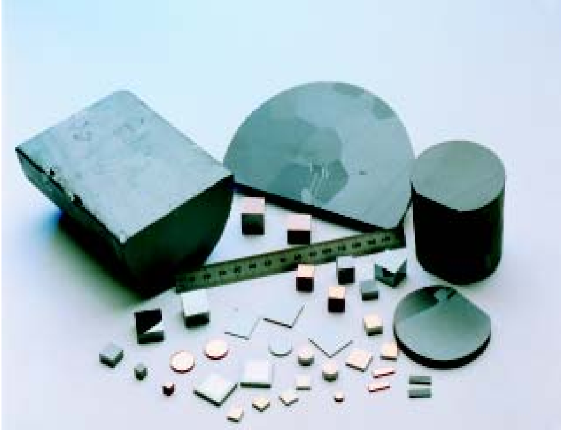
Fotoğraf 3.1 CdZnTe yarı iletkeni blok ve parçaları [11]
