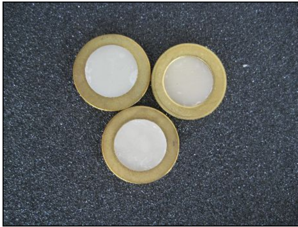
Resim 2: Metal kalıp içerisinde hazırlanan kompozit örnekler
