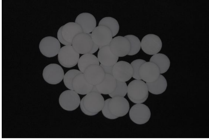
Resim 8: Sinterlenmesi tamamlanmış ve orijinal boyutlarına ulaşmış ZirkonZahn diskler
