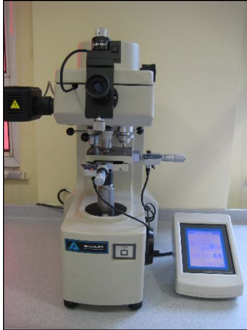
Resim 37: Buehler Vickers sertlik ölçme cihazı
