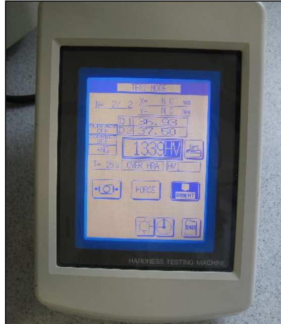
Resim 39: Vickers sertlik ölçme cihazında elde edilen değerin okunması
