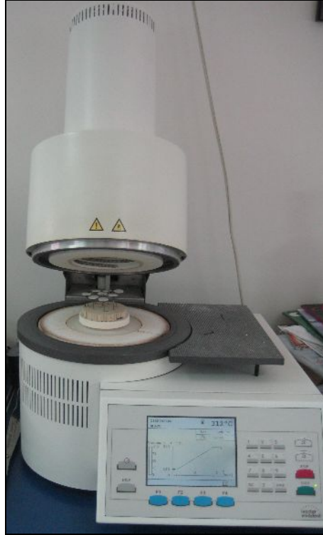
Resim 26: ZirkonZahn ve Ceramill örnekler glazür uygulanan vakumlu fırın
