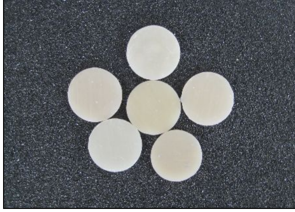
Resim 3: Işıkla polimerize olan kompozit rezin materyali ile hazırlanan diskler
