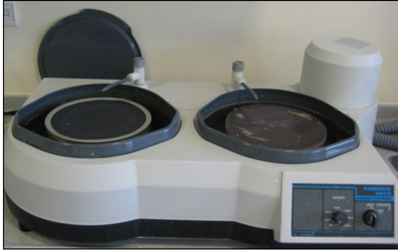
Resim 22: Phoenix Beta Grinder/ Polisher zımpara cihazı
