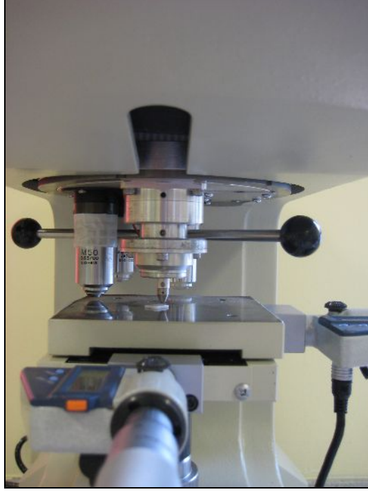
Resim 38: Vickers sertlik ölçme cihazında örneklerin incelenmesi
