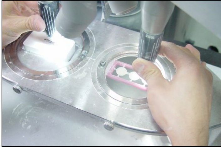
Resim 7: Makinenin kazıyıcı ünitesine yerleştirilen ZirkonZahn blok
