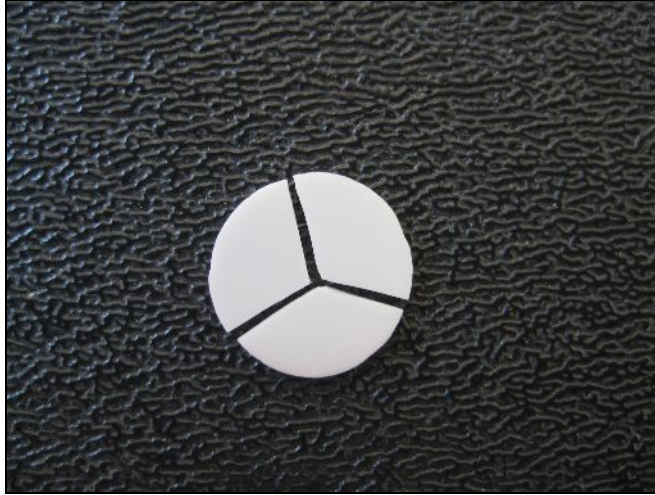
Resim 36: Instron cihazında kırılmış örnek
