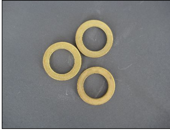
Resim 1: Örneklerin hazırlanmasında kullanılan metal silindir kalıplar
