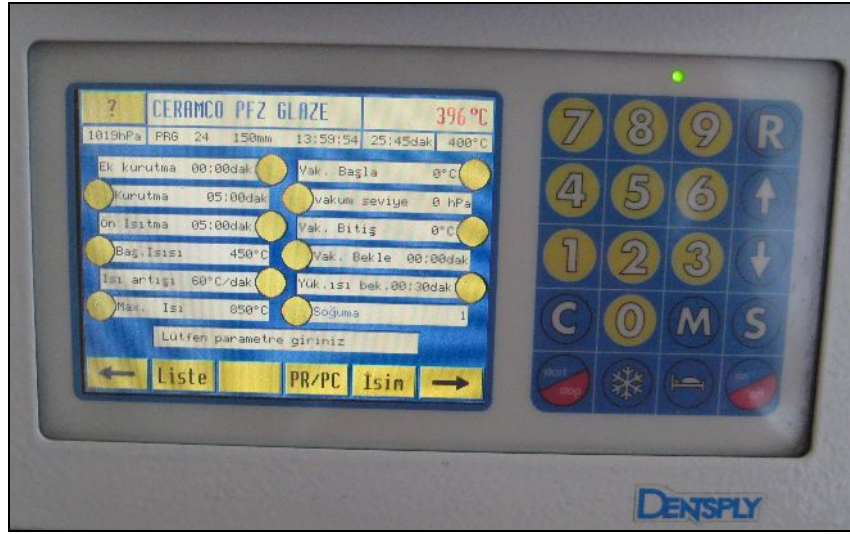
Resim 29: Cercon örneklere glazür uygulanan fırının sıcaklık değerleri
