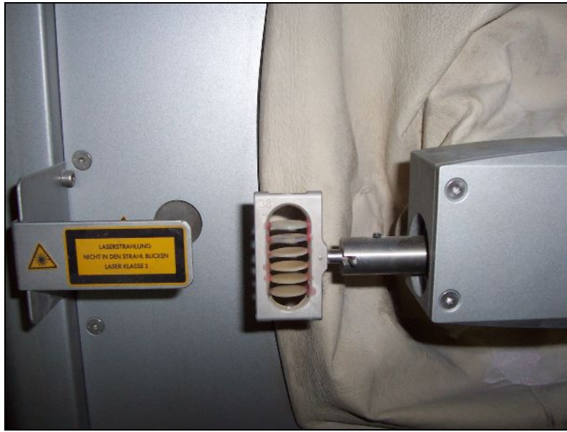
Resim 10: Kompozit rezin alt yapı dizaynlarının tarama ünitesine yerleştirilmesi
