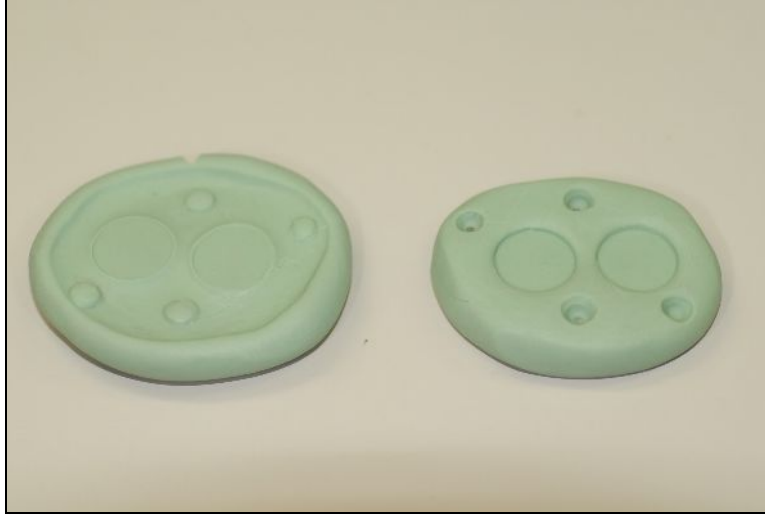
Resim 14: Kompozit disk örneklerden hazırlanan silikon kalıp
