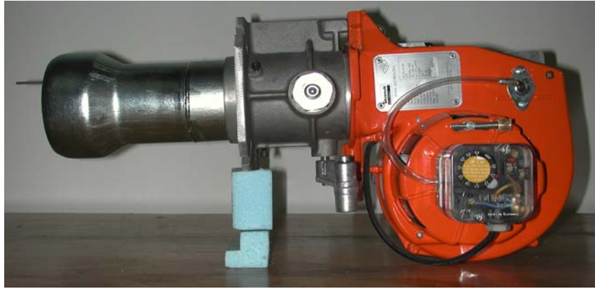
řekil 4.4: Deneylerde kullanılan üflemeli brölör.
