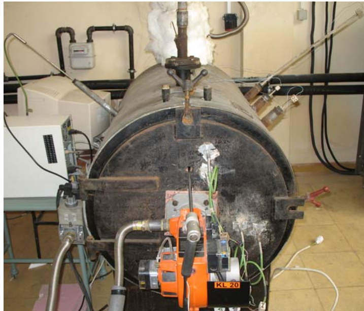
Şekil 4.6: Kazana bağlanan termoelemanların görünüşü
