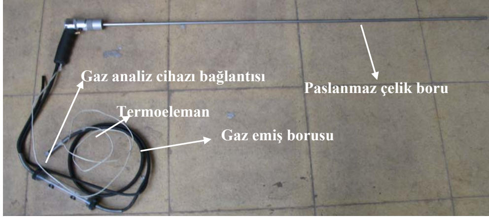
Şekil 4.5: Gaz analizinde kullanılan prob
