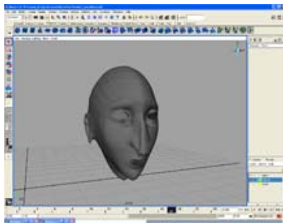
(Görüntü:217) Parçalardan oluşan nurbs yüzeylerin polygona çevrildikten ve birleştirildikten sonraki hali
