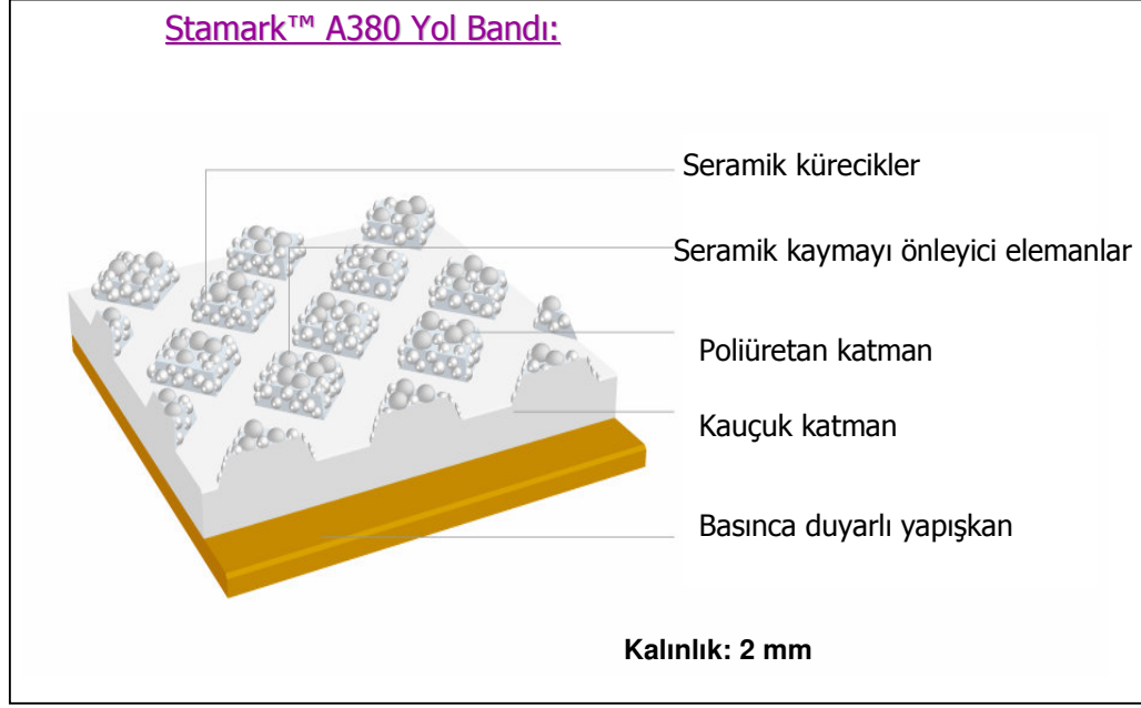
Şekil 5.14: Stamark A380 Yol Bantı Kesiti [4]
