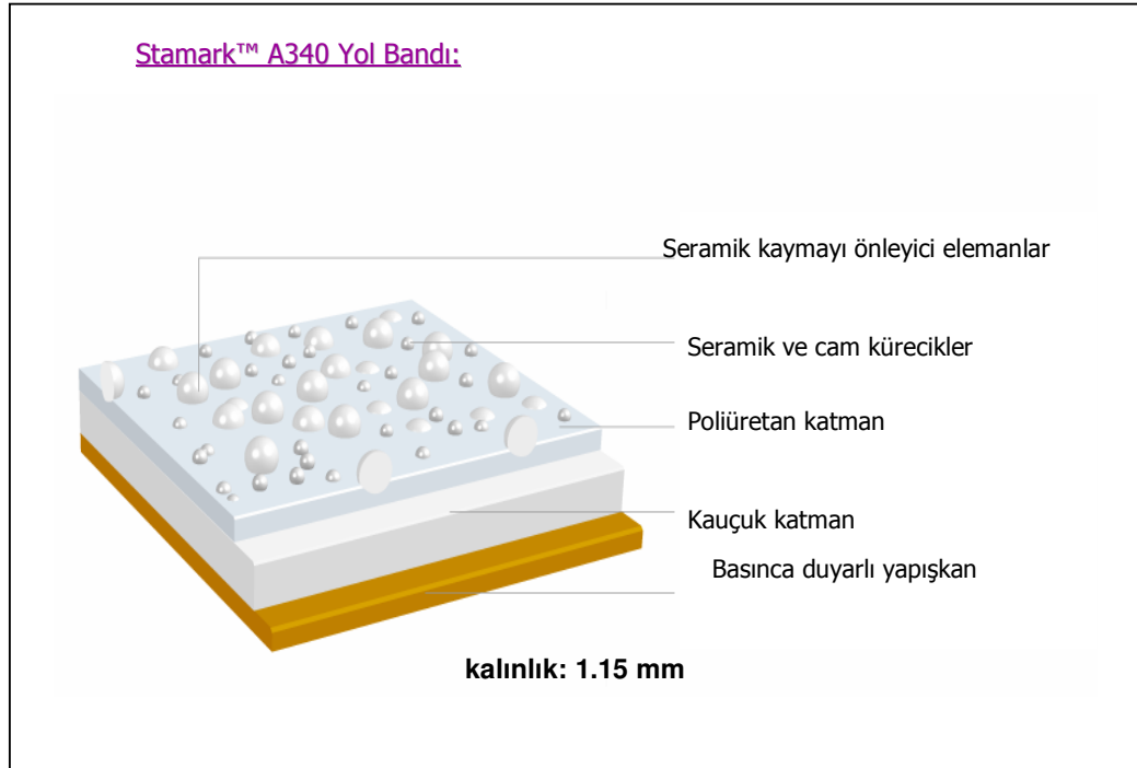
Şekil 5.13:Stamark A340 Yol Bandı Kesiti [4]
