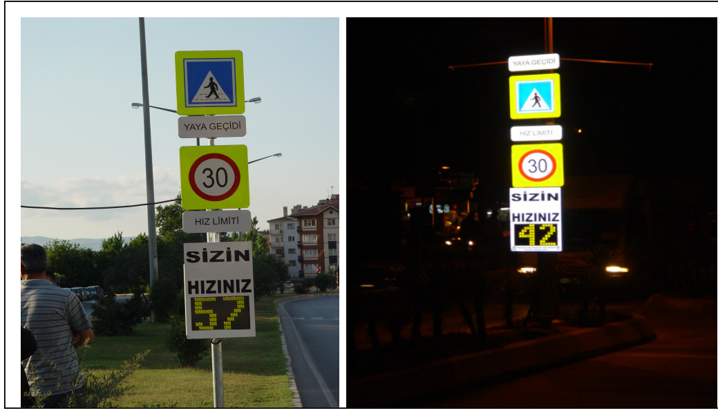
Şekil 5.18: DFS Sistemlerinin Gece ve Gündüz Görünüşü
