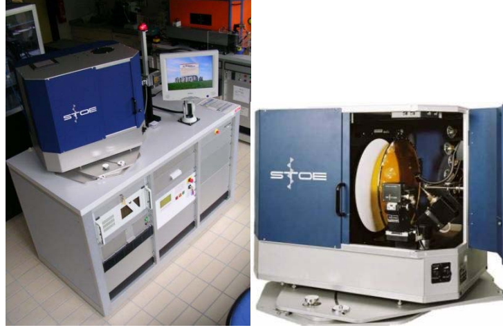
Şekil 4.4. STOE IPDS II Difraktometresinin görünümü
