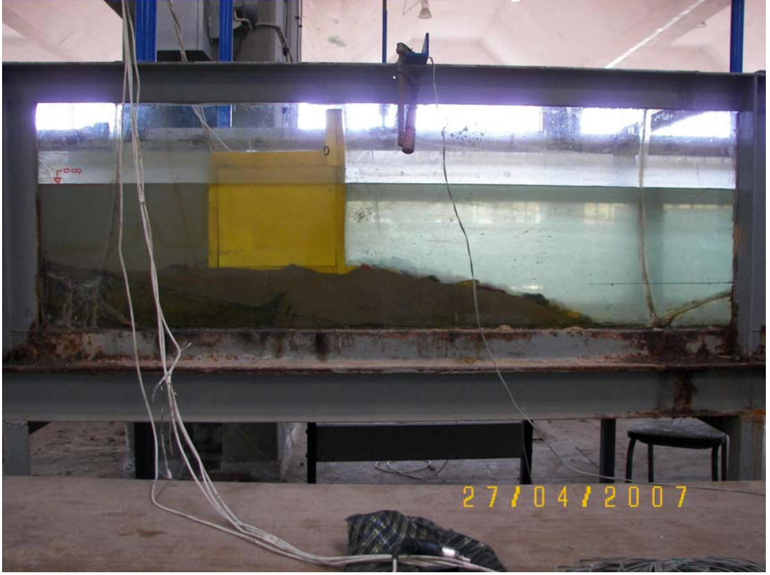
Şekil 3.12: Keson II palyesiz konfigürasyonun deney kanalı içindeki görünümü
