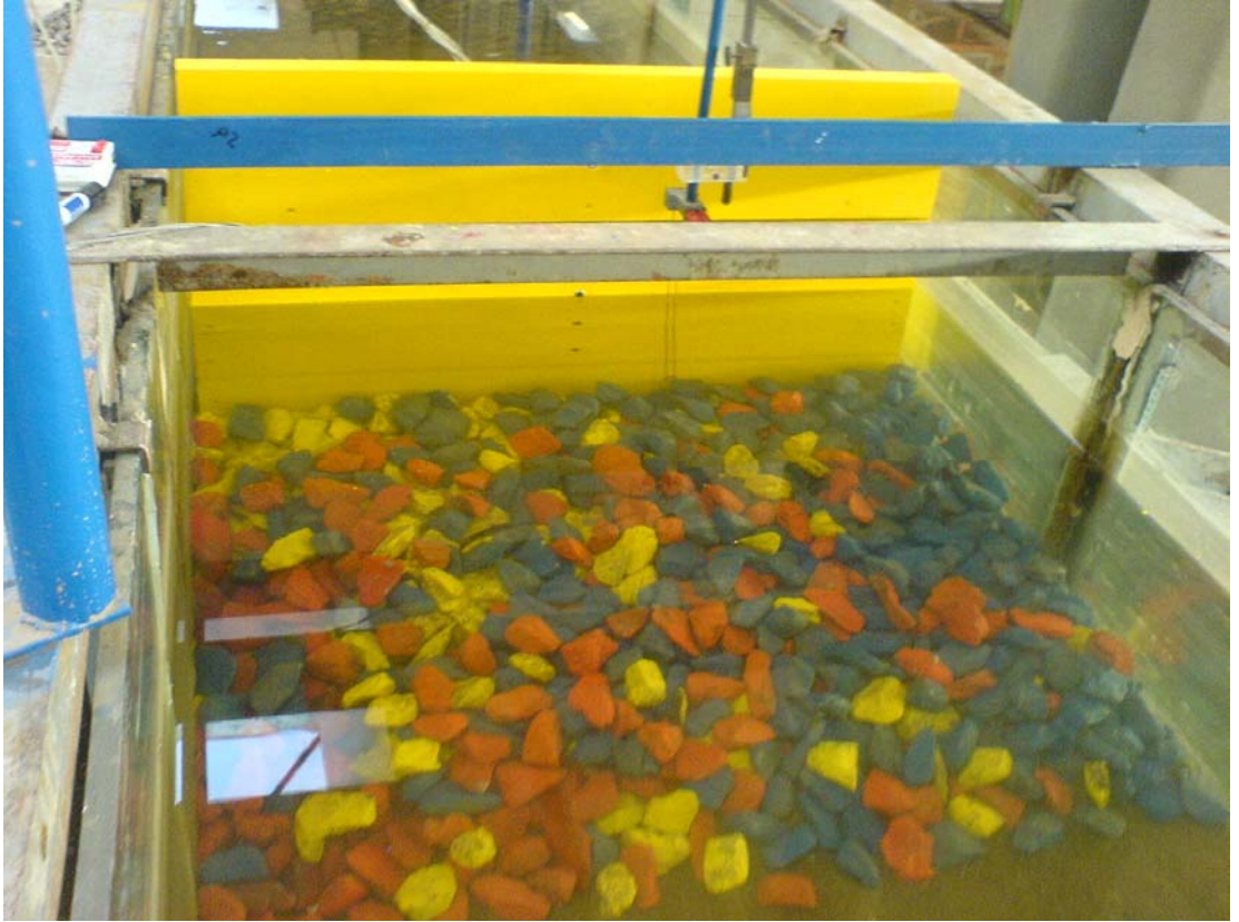
Şekil 3.9: Keson I palyeli konfigurasyon ve yapı önu dalga probunun kanal içindeki görünümü
