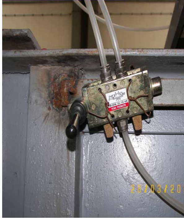
Şekil 3.5: Yatay levhaya bağlı pistonu iki farklı yönde çalıştırabilen el kumandalı sürgülü tip valf
