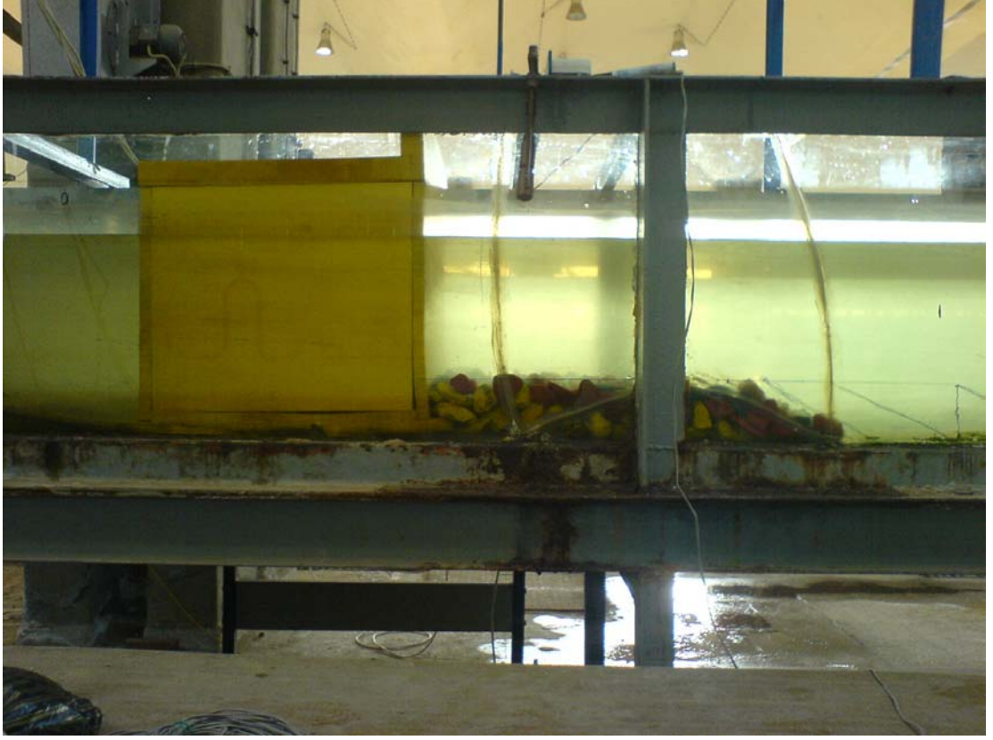
Şekil 3.8: Keson I palyeli konfigurasyonun kanal içindeki görünümü
