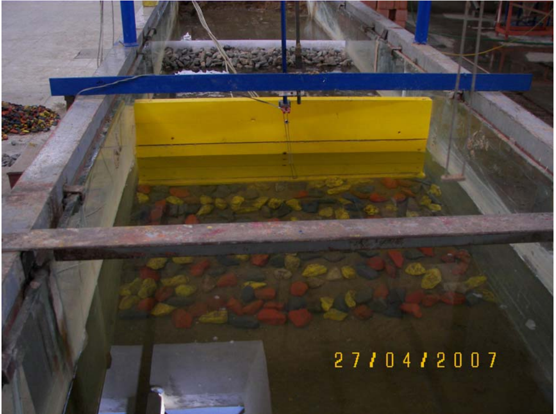
Şekil 3.13: Keson II palyesiz konfigürasyon ve yapı önu dalga probunun kanal içindeki görünümü
