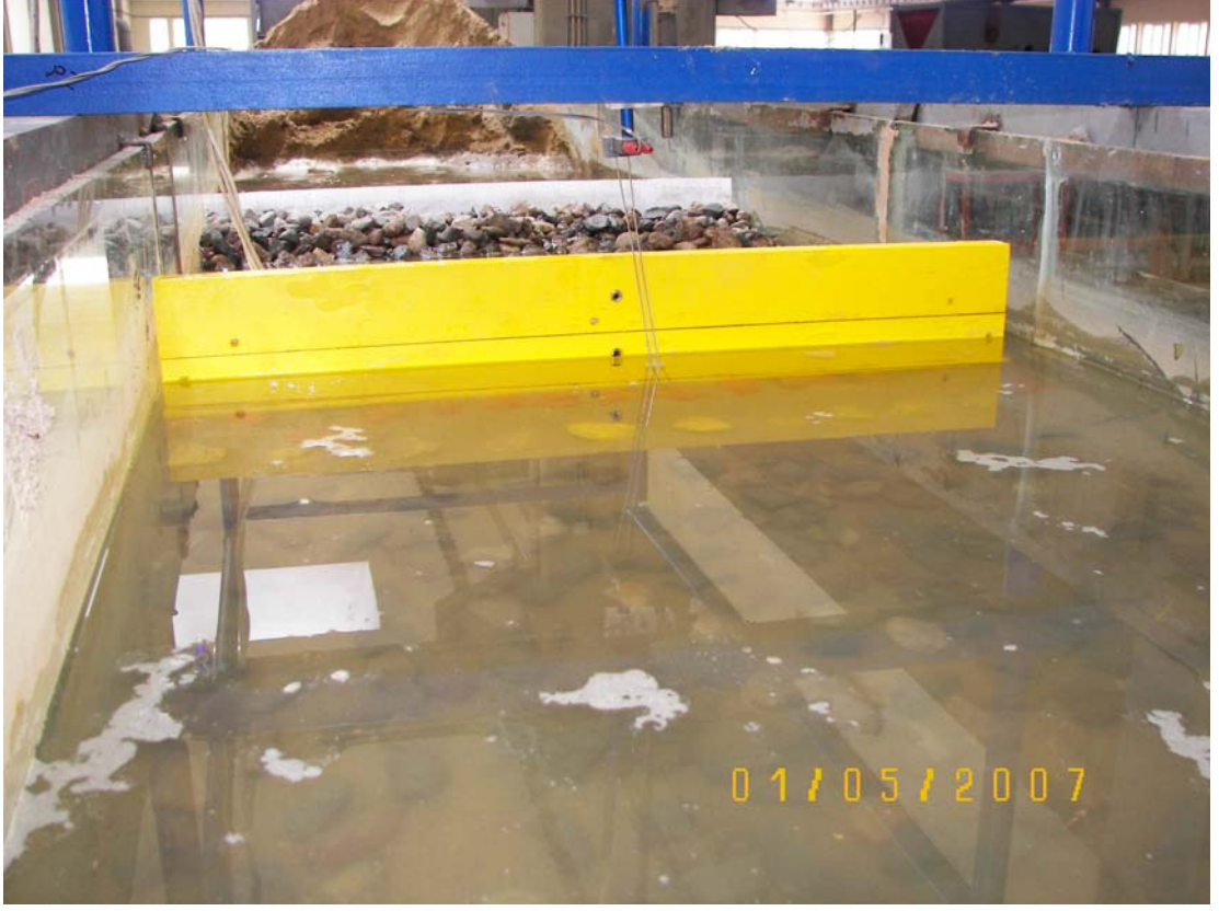
Şekil 3.17: Keson III palyesiz konfigürasyon ve yapı önü dalga probunun kanal içindeki görünümü
