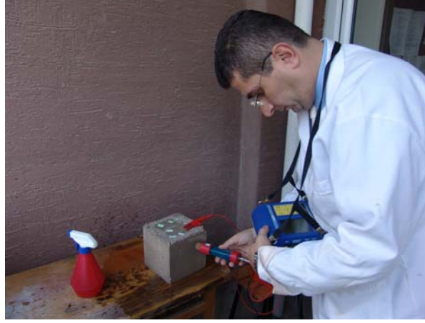
Şekil 3.8 Betonarme numune donatılarının potansiyelinin ölçülmesi
