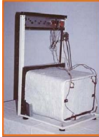
Şekil 2.4: İğnelenmiş cam yünü uygulaması
