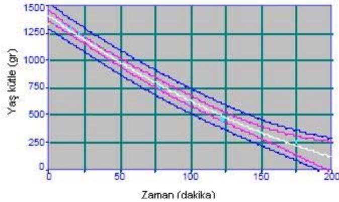
Şekil 2.28: Tuğla testi sırasında tuğla kütle kaybının zamana bağlı değişimi
