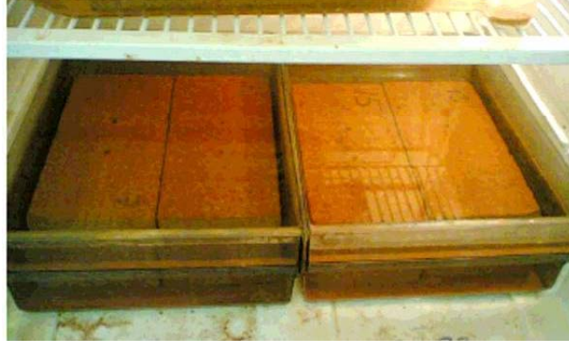
Şekil 2.25: Tuğlaların buzdolabında su içerisinde bekletilmesi
