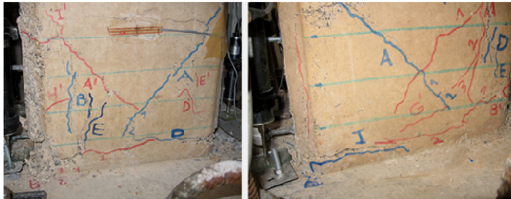
Şekil 4.33 Öteleme Oranı %3.00 Düzeyinde Hasar Durumu
