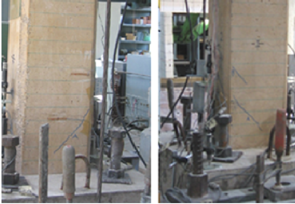
Şekil 4.30 : Öteleme Oranı %0.50 Düzeyinde Hasar Durumu
