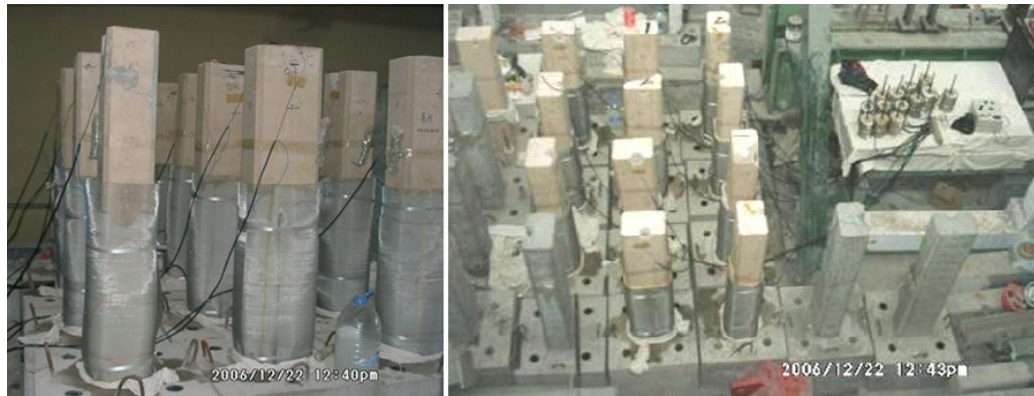
Şekil 3.28 : Hızlandırılmış Korozyona Tabii Tutulan Kolon Numuneleri
