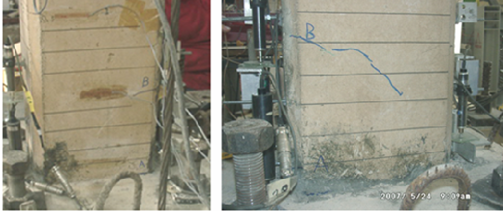
Şekil 4.17 : LS-C1 Numunesinde İlk Çatlak Oluşumu
