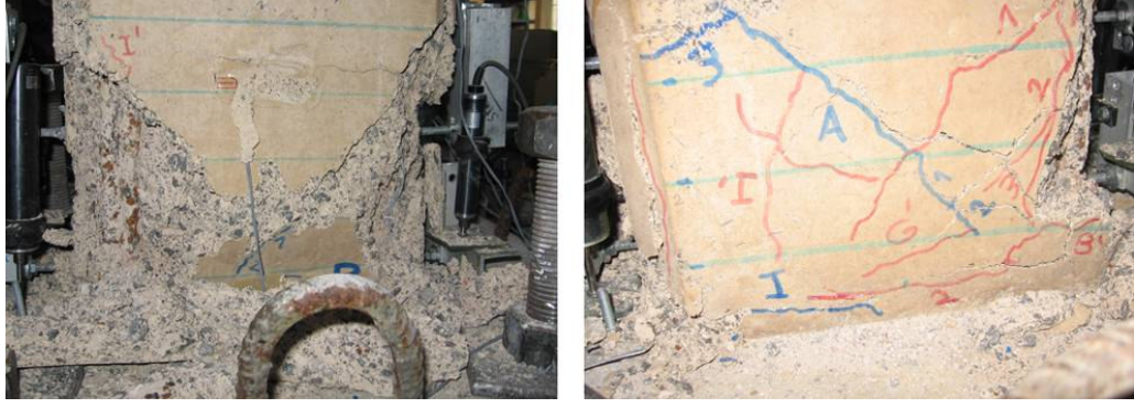
Şekil Ek A. 29 : Çatlak Bölgesi (Ö.O. : % 4.00)
