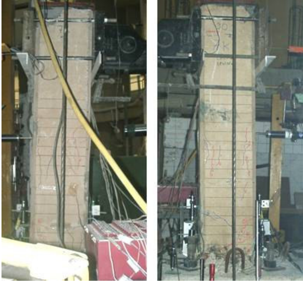
Şekil 4.20 : Deney Sonu Çatlak Durumu (Öteleme Oranı %6.00)
