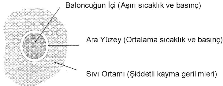
Şekil 2.7: Kavitasyon Baloncuğunun Homojen Sıvı Sistemi Üzerindeki Etkileri [4]
