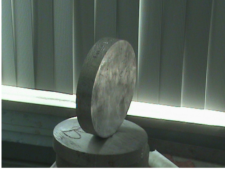
Şekil 6.1. Biletten çıkarılan enine numunelerin hazırlandığı parça
