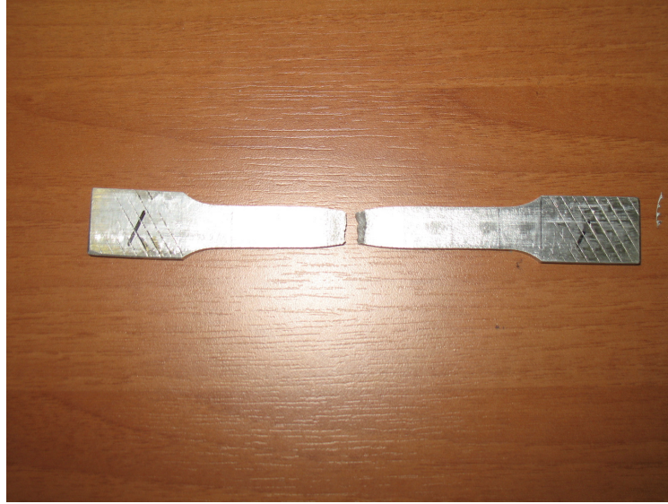
Şekil 7.7. Biletten hazırlanan boyuna numunenin çekme testi sırasında kopma şekli
