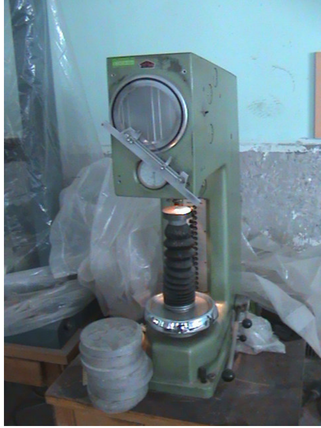
Şekil 6.3. Sertlik deneyi için kullanılan test cihazı ve sertlik numuneleri.
