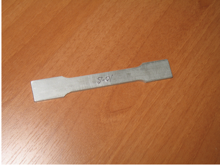
Şekil 6.6. Çekme deneyi için hazırlanan yassı çekme çubuğu
