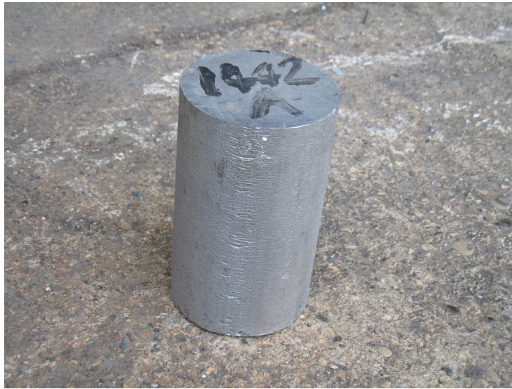
Şekil 6.2. Biletten çıkarılan boyuna numunelerin hazırlandığı parça
