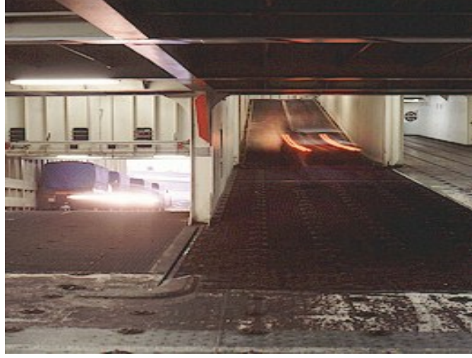
Şekil 4.3: 180 Derecelik Dönüş Gerektiren Bir RO-RO Gemisi Güvertesi
