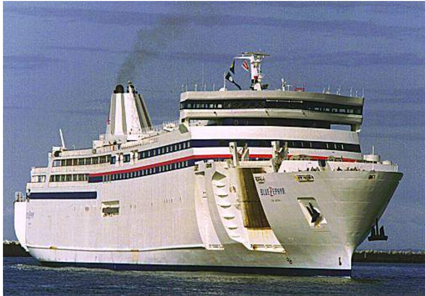
Şekil 2.11: Barber Blue Sea şirketinin, sancak baş omuzluğunda yan rampası bulunan gemisi.
