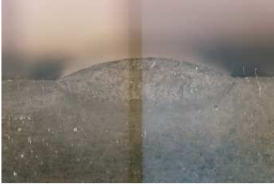
Şekil 6.3: 55 Hd elektrotla kaynak işlemine maruz kalan çeliğin kaynak bölgesinin makro yapısı
