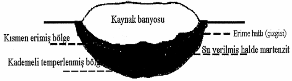
Şekil 6.6: Isı tesiri altında kalan bölgenin metalurjik yapısı
