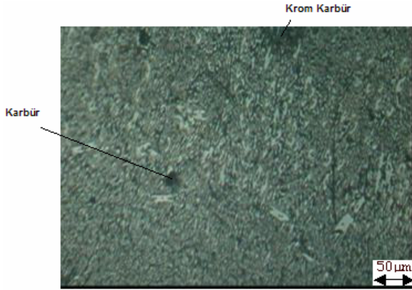
Şekil 6.9: Isı tesiri altında kalan bölgedeki tane yapısı
