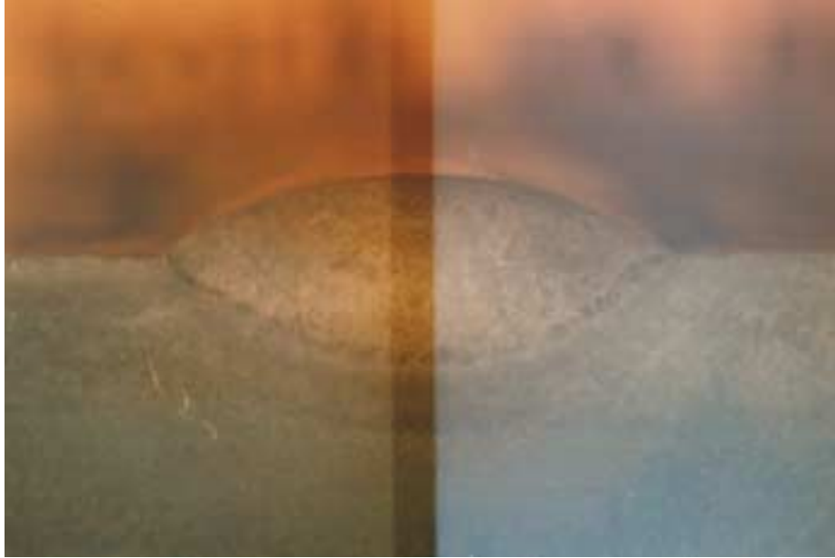
Şekil 6.2 : E6-UM55GRP ve E10-UM60GRZ elektrotla kaynak işlemine maruz kalan çeliğin kaynak bölgesinin makro yapısı
