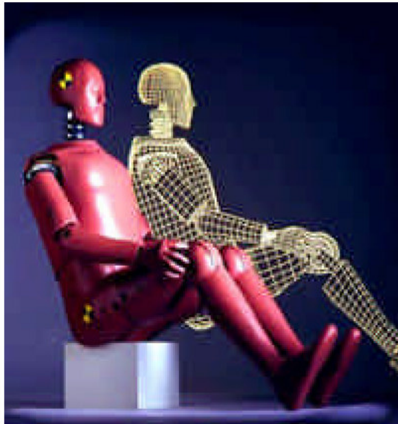
Şekil 4.9: Helikopter pilot koltuğu deney mankeni (%95 erkek)
