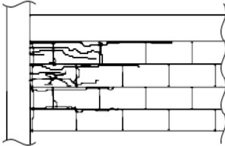
Şekil 3.3 : Diyagonal gerilme sonucun oluşan köşe çatlakları
