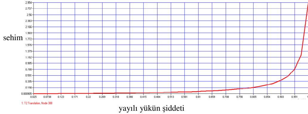
Şekil 4.3: Analiz Sonuçlarına Göre Oluşturulan Yükleme-Şekil Değiştirme Eğrisi
