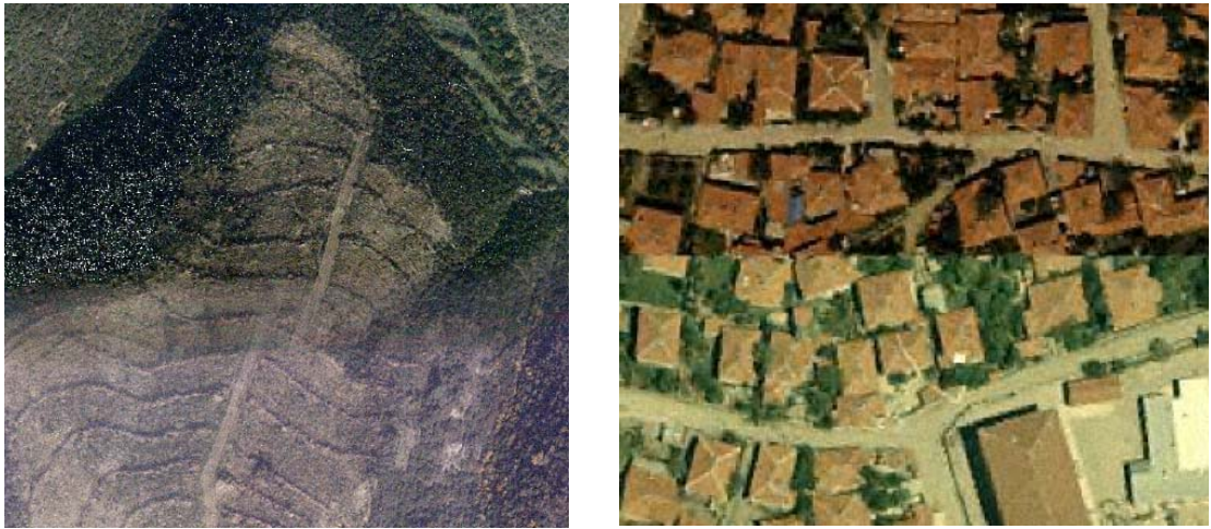
Şekil 3.13: 10 m. aralıklı eş yükseklik eğrisi kullanılarak üretilmiş 1/5.000 ölçekli ortofoto haritada meydana gelebilecek hatalar
