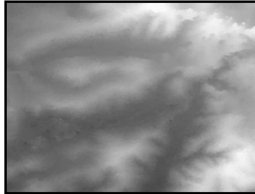
Şekil 4.31: İzmir bölgesinde SPOT uydu görüntülerinden otomatik görüntü eşleme ile üretilen SYM
