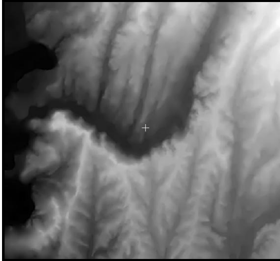
Şekil 4.34: SPOT uydu görüntülerinden değerlendirilen eş yükselti eğrilerinden üretilen SYM
