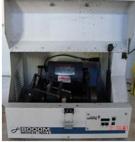
Şekil 3.8: Mekanik alaşımlamada kullanılan yüksek enerjili bilyalı öğütücü
