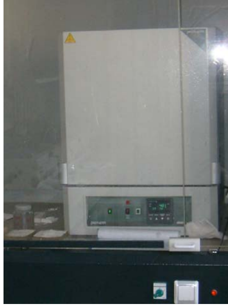
Şekil 4.17: PROTHERM™ Bağlayıcı giderme fırını
