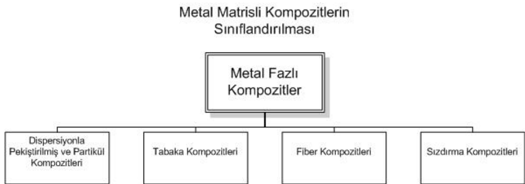
Şekil 2.2: Metal matrisli kompozit malzemelerin sınıflandırılması (Kainer, 2006)
