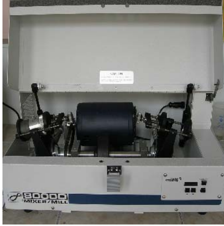
Şekil 4.4: (a) SPEX™ Yüksek enerjili bilyalı öğütücü, (b) Kapalı ortam kutusu
