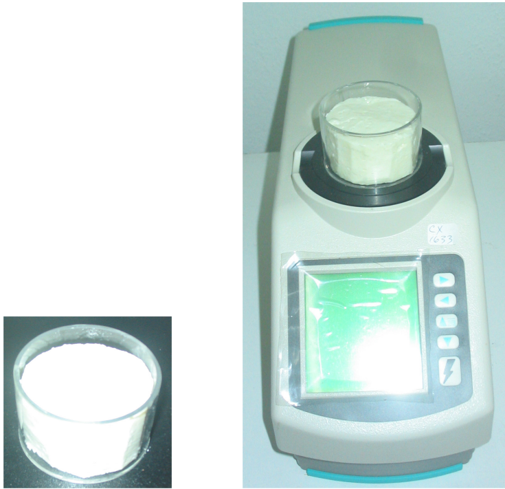
Resim 3.15. Kesiti Alınıp Numune Kabına ve Cihaza Yerleştirilen Peynir Örneği
