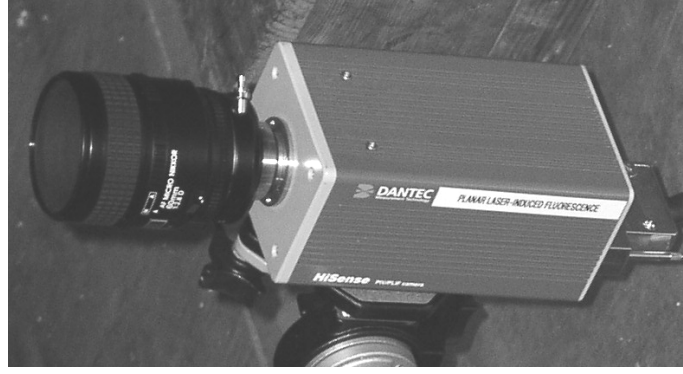
Şekil 2.6 : DanTec 80C60 HiSense Dijital Kamera ve Nikon f:2.8 Objektifi Bir Arada
