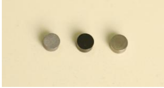
Şekil 3.1: Elektrokimyasal test örnekleri. (Soldan itibaren) Ni-Cr, DLC kaplı Ti, Ti
