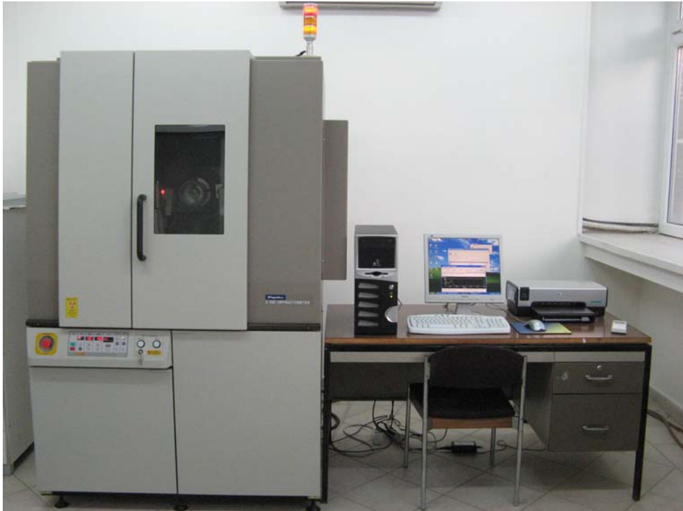
Şekil 3.2.2. Dentin örneklerinin X ışını kırınım grafiğinin çekildiği cihaz
