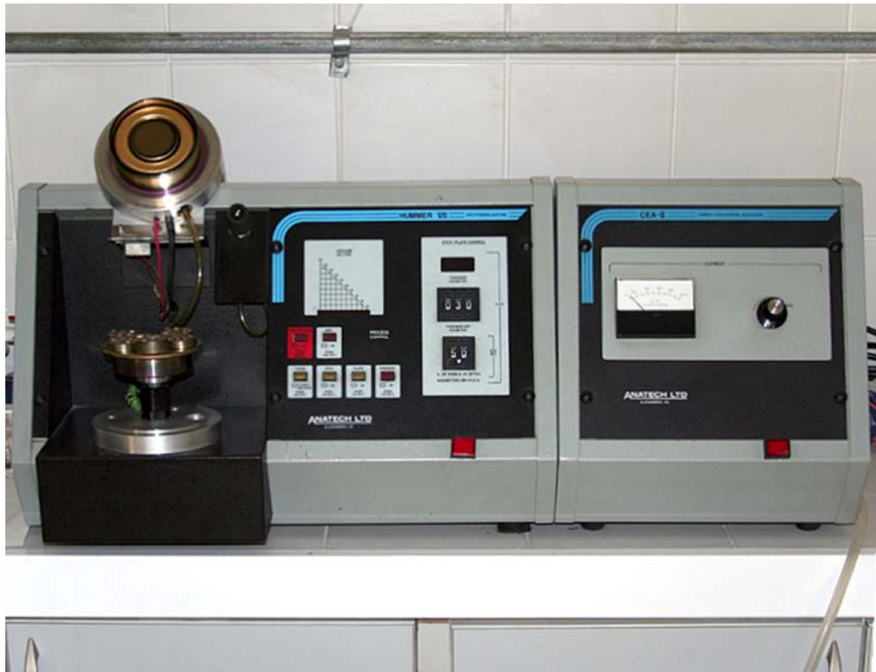
Şekil 3.1.2. SEM örneklerinin altınla kaplandığı cihaz
