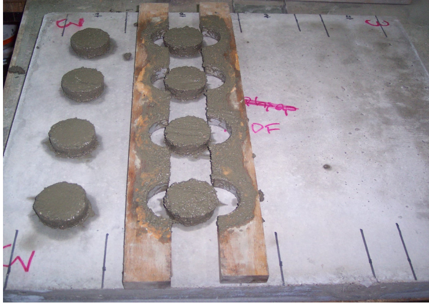
Şekil 5.2. Özel hazırlanmış sıva kalıbı
