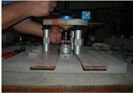
Şekil 5.9. Pull-off deney düzeneği
