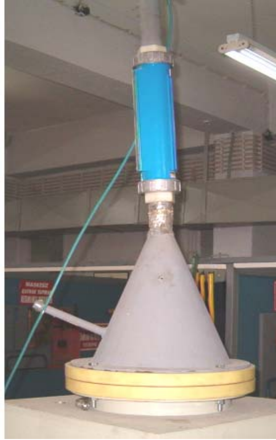
Şekil 5.2 Birbirlerine cıvata-somun bağlantısıyla birleştirilen baca, hazne ve arasında filtre kâğıdı bulunan iki halka sızdırmazlık elemanı. Bacanın üzerinde debi ölçer görülmektedir.
