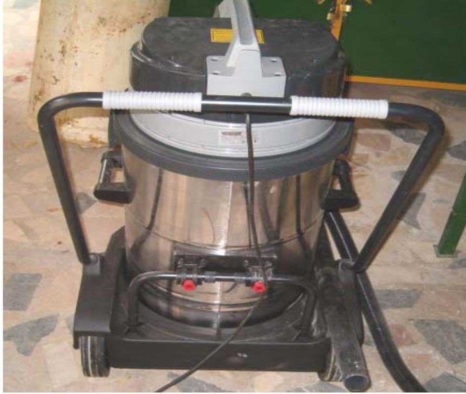
Şekil 5.4 Gerekli vakumu sağlamak için kullanılan 3 motorlu endüstriyel vakum cihazı
