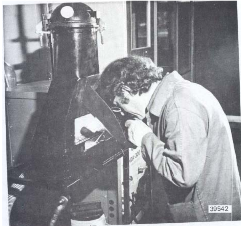
Şekil 4.5 Kaynak Enstitüsü partikül haznesinde deney yapılırken [46]
