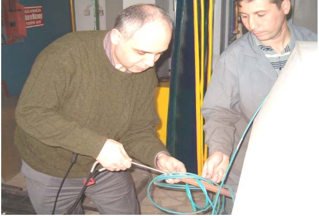
Şekil 5.8 Baca gazı analiz cihazının probu deney öncesinde hazneye yerleştirilirken.
