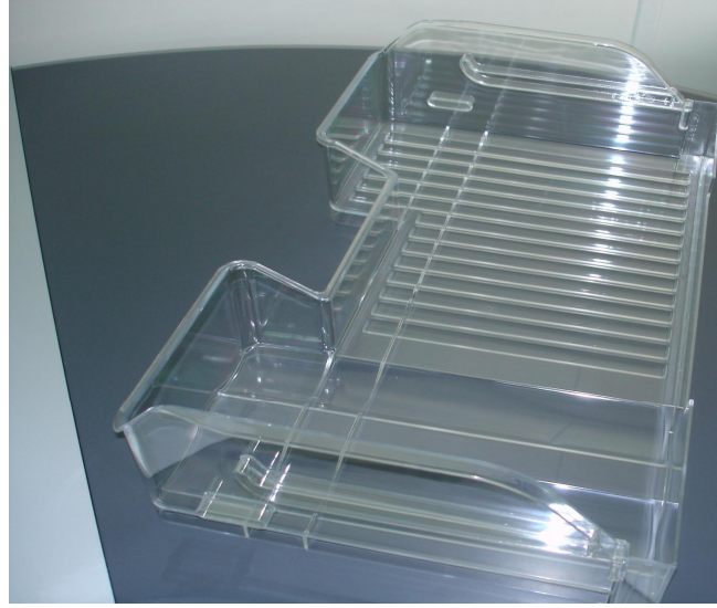
Şekil 6.7: Sehim ve rijitlik problemi olan parça
