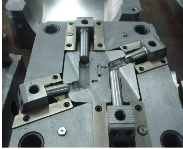
Şekil 3.14: Açılı hareketli (maçalı) kalıbın a-) Dişi Kalıp b-) Erkek Kalıp
