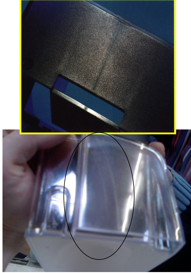
Şekil 6.19: Malzeme birleşim izleri
