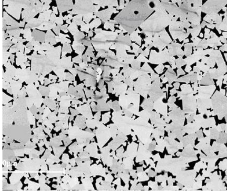
Şekil 5.22: Chalmers Üniversitesi'nde Yapılmış Bir Çalışmada Elde Edilen % 6 Co İçeren WC-Co Malzemeye Ait BSE Görüntüsü (10000X)
