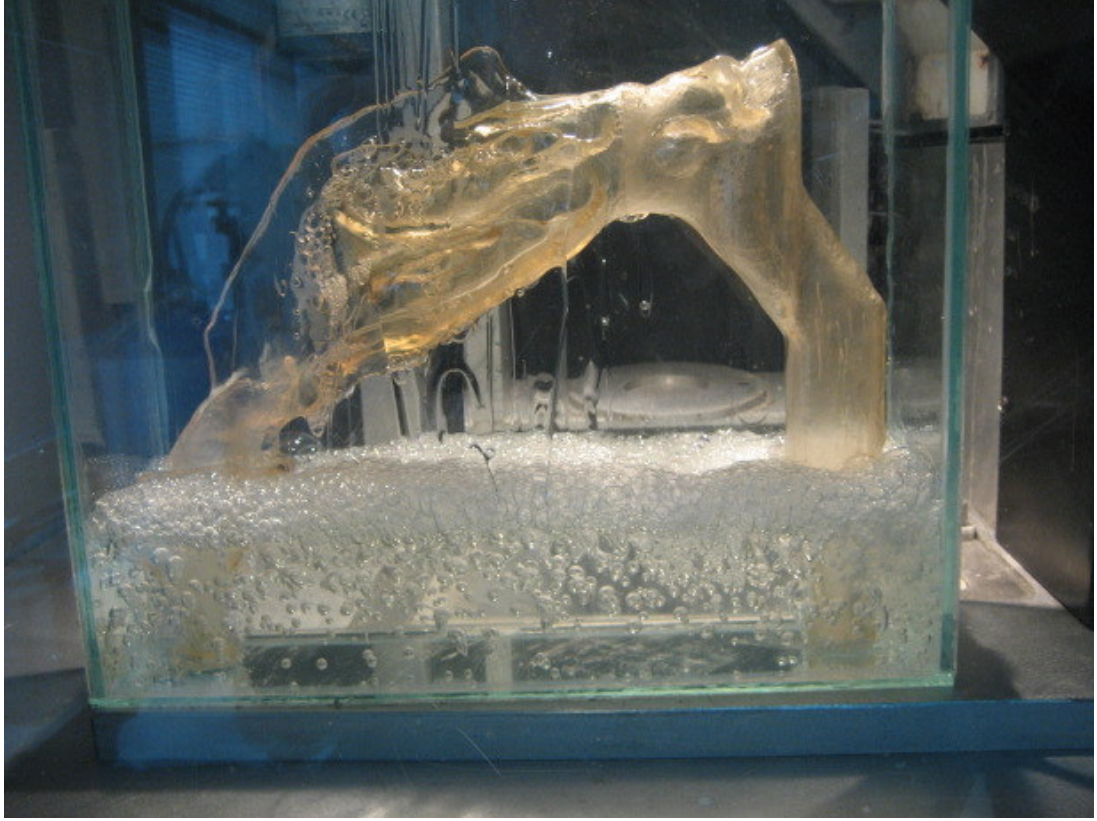
Şekil 4.2 : Kalıp silikonunun dökümü
