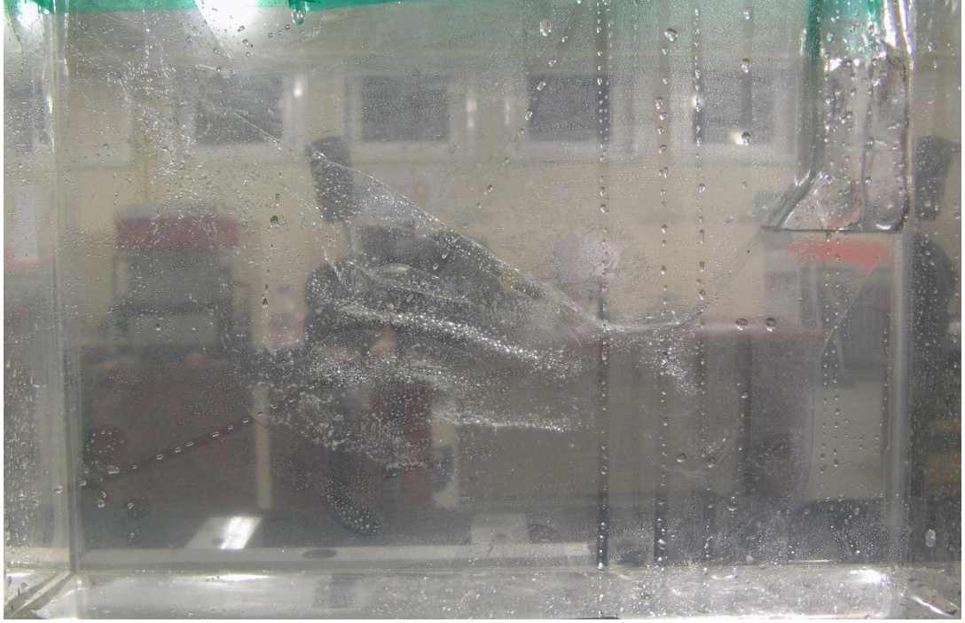
Şekil 4.6 : Gliserin-Su Karışımıyla Dolu Silikon Model
