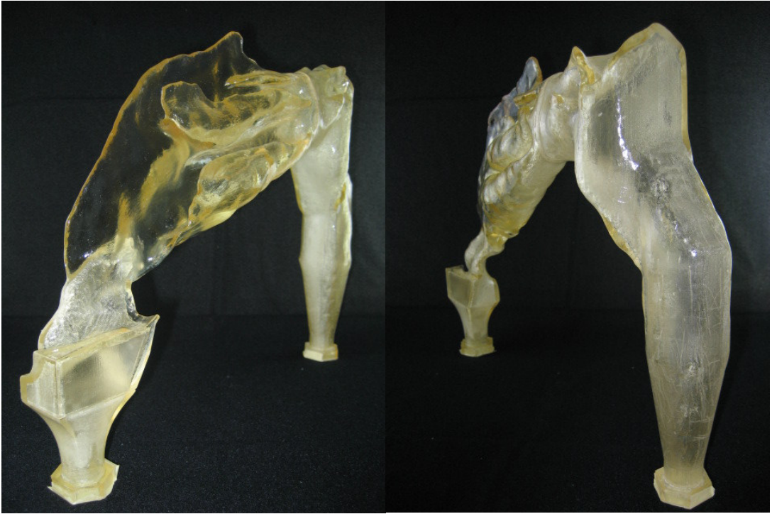
Şekil 4.1 : Hızlı prototipleme yöntemiyle oluşturulan katı model
