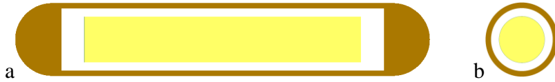
Şekil 3.21. Model 6711 kaynağının kesiti: a* boyuna kesiti, b* enine kesiti. (boyuna kesitler y-z, enine kesitler x-y düzleminde.) (ID: 2090)
