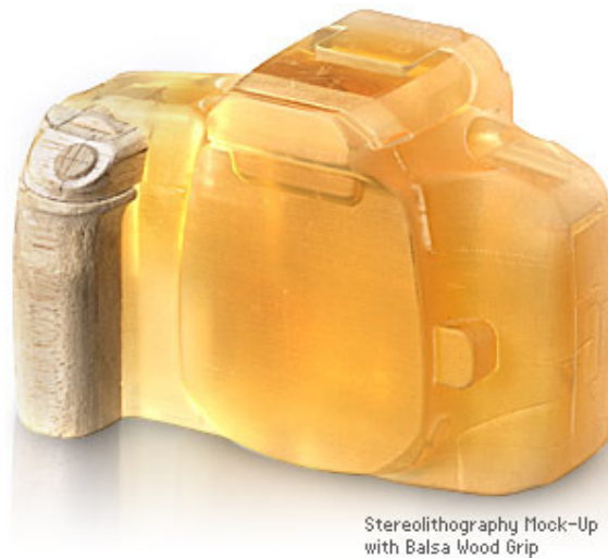
Resim 2.1 Stereolithography Teknięi İle Üretilmiş Model(45)
