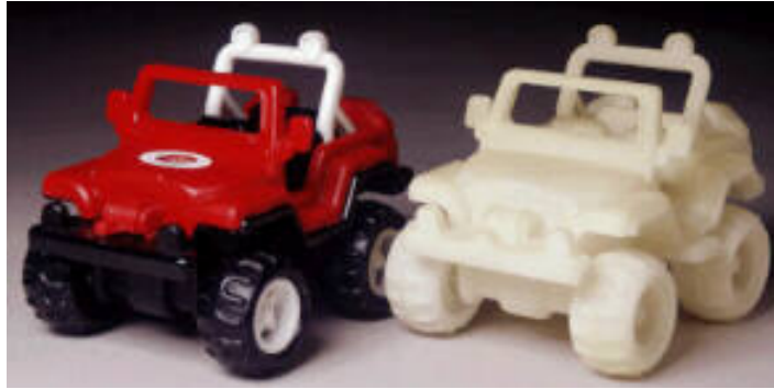
Şekil 2.6. Cubital Firması tarafından SGC yöntemiyle üretilmiş bir model. Soldaki model daha sonra elle boyanmıştır.
