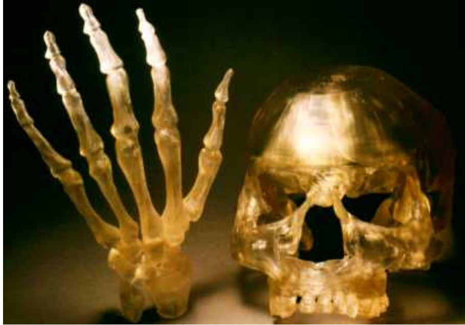
Şekil 2.4. Stereolithography yöntemiyle elde edilmiş insan kafatası ve el iskeleti ( www.media.mit.edu )
