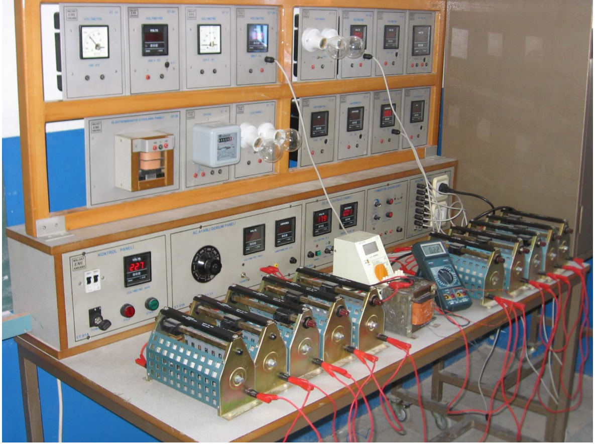
Şekil IV.5 Model Transformatörün Çıkışına Bağlanan Reostalar ve Ölçü Aleti
