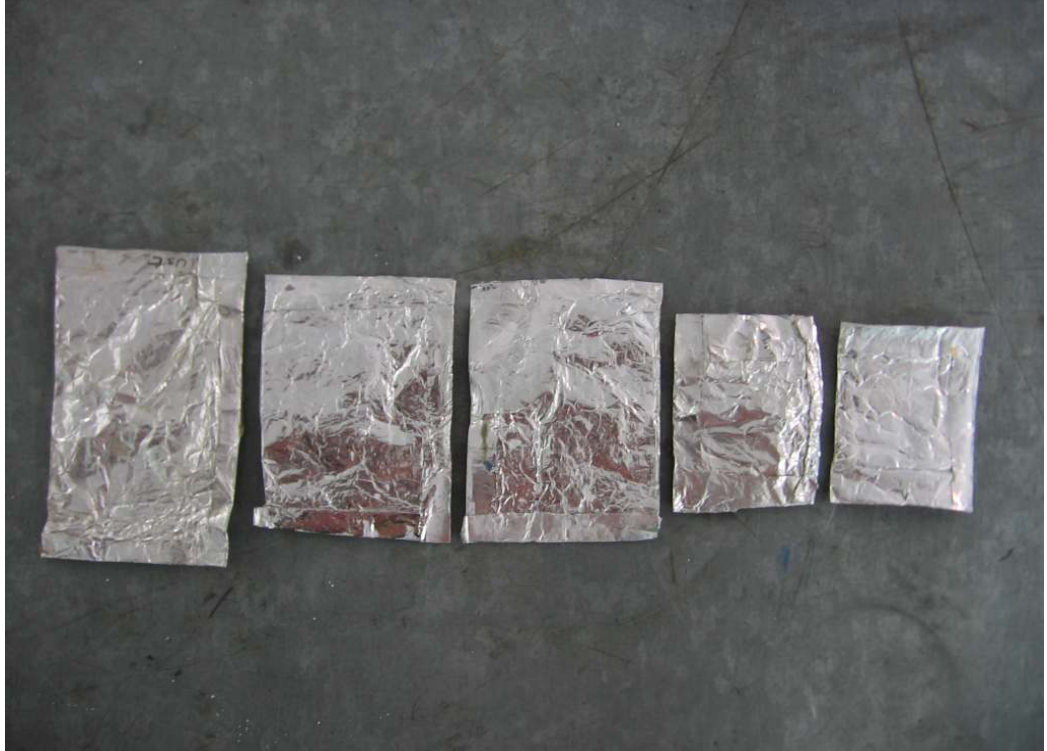
Şekil IV.7 Deney Transformatörüne Eklenen PCM Malzeme Paketleri
