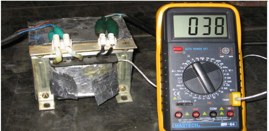
Şekil IV.6 Model Transformatörün Numaralandırılmış Kısımlarından Boş Alüminyum Folyo Sarılmış Sıcaklık Değerlerinin Alınması
