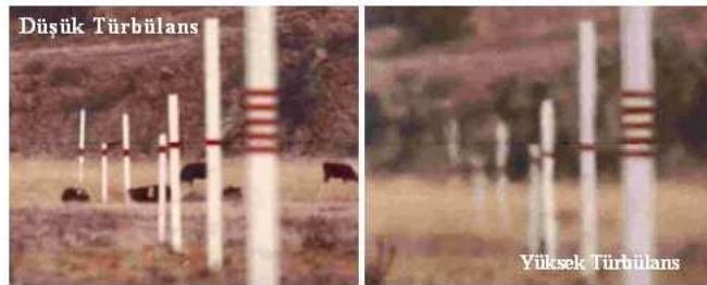
řekil 2.19: Türbölansın görüntü üzerinde oluřturduęu buęulanma
