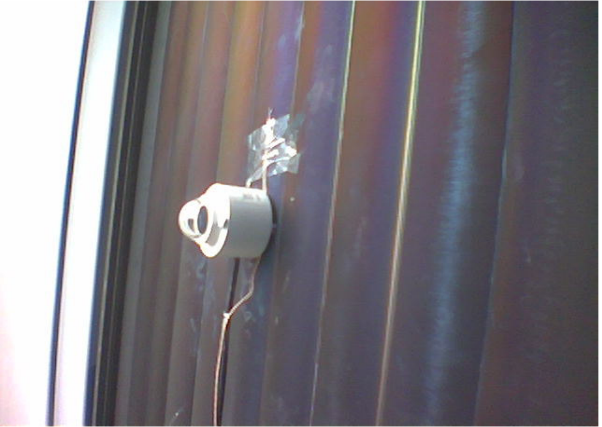
Fotograf: 5.3 Güneş'ten gelen ısı kazancının ölçümü
