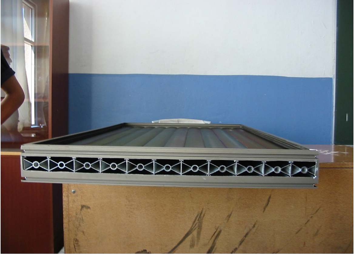
Fotograf :5.1 Güneş toplacının kesiti
