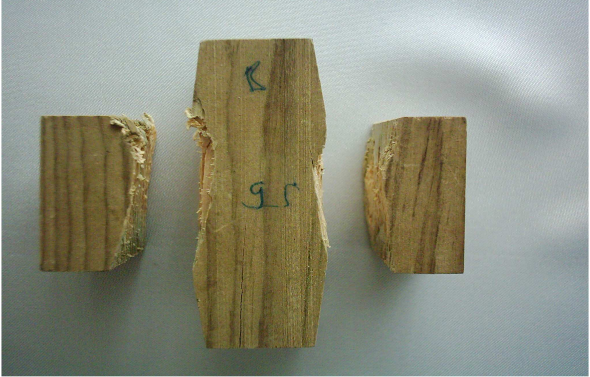
Şekil 3.15. Makaslama direnci örneği test sonrası görüntüsü (Foto BAL).
