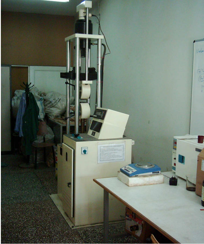
Şekil 3.3. Üniversal ağaç test makinesi (KSÜ Orman Fakültesi Odun mekaniği laboratuvarından) (Foto BAL)
