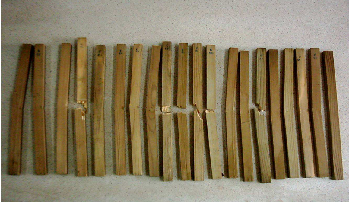
Şekil 3.5. Eğilme direnci örneklerinin test sonrası görüntüsü (Foto BAL).
