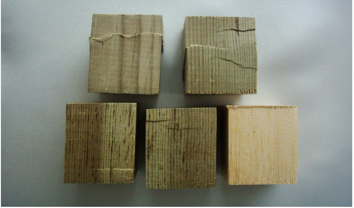
Şekil 3.12. Liflere paralel basınç direnci örneklerinin test sonrası görüntüsü (Foto BAL).
