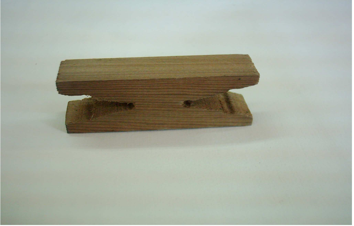
Şekil 3.9. Liflere dik çekme direnci örneğinin görüntüsü (Foto BAL).
