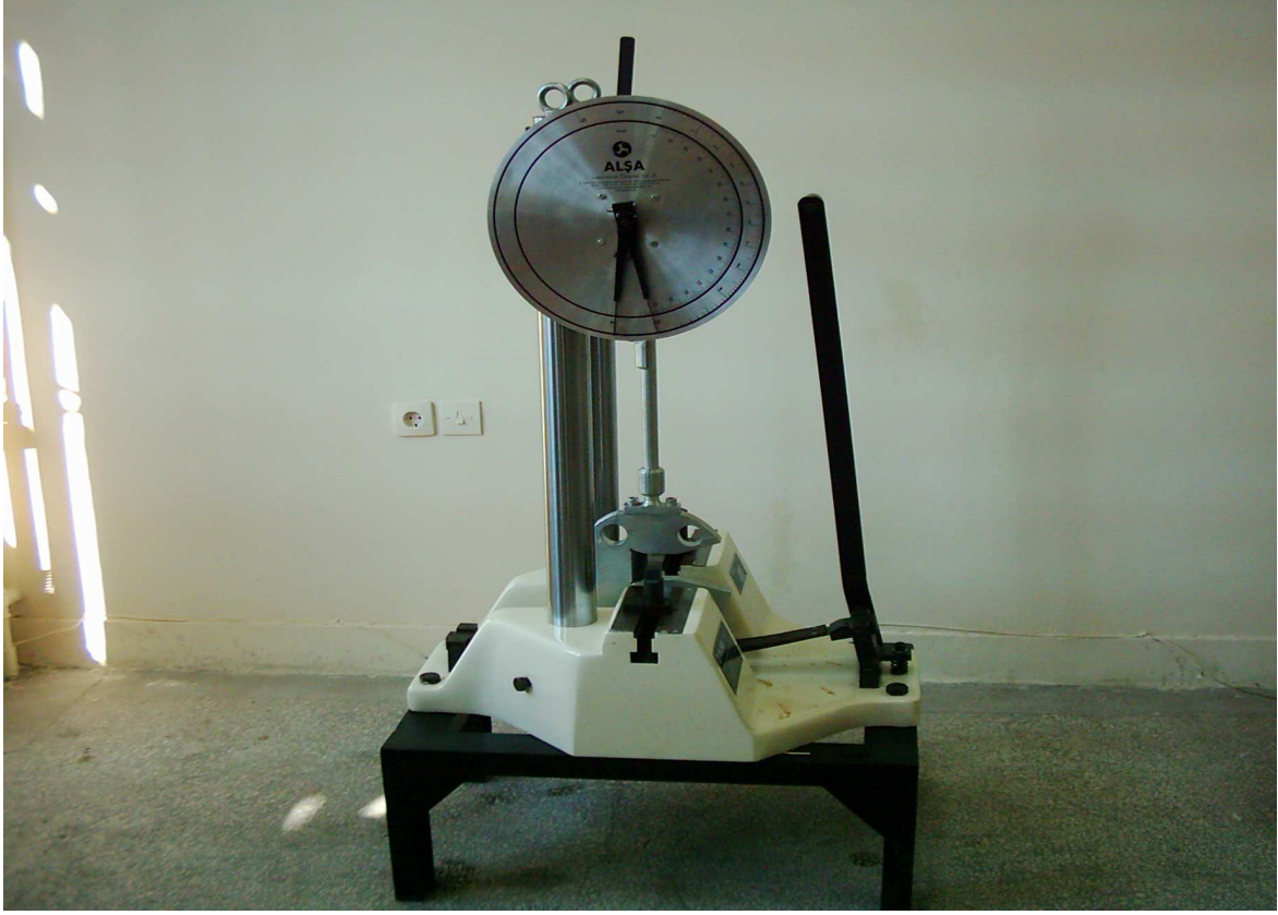
Şekil 3.18. Şok direnci test aleti (KSÜ Orman fakültesi, Odun mekaniği laboratuvarından) (Foto BAL).
