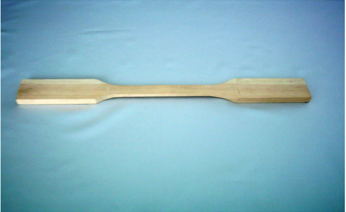
Şekil 3.7. Liflere paralel çekme direnci örneğinin görüntüsü (Foto BAL).
