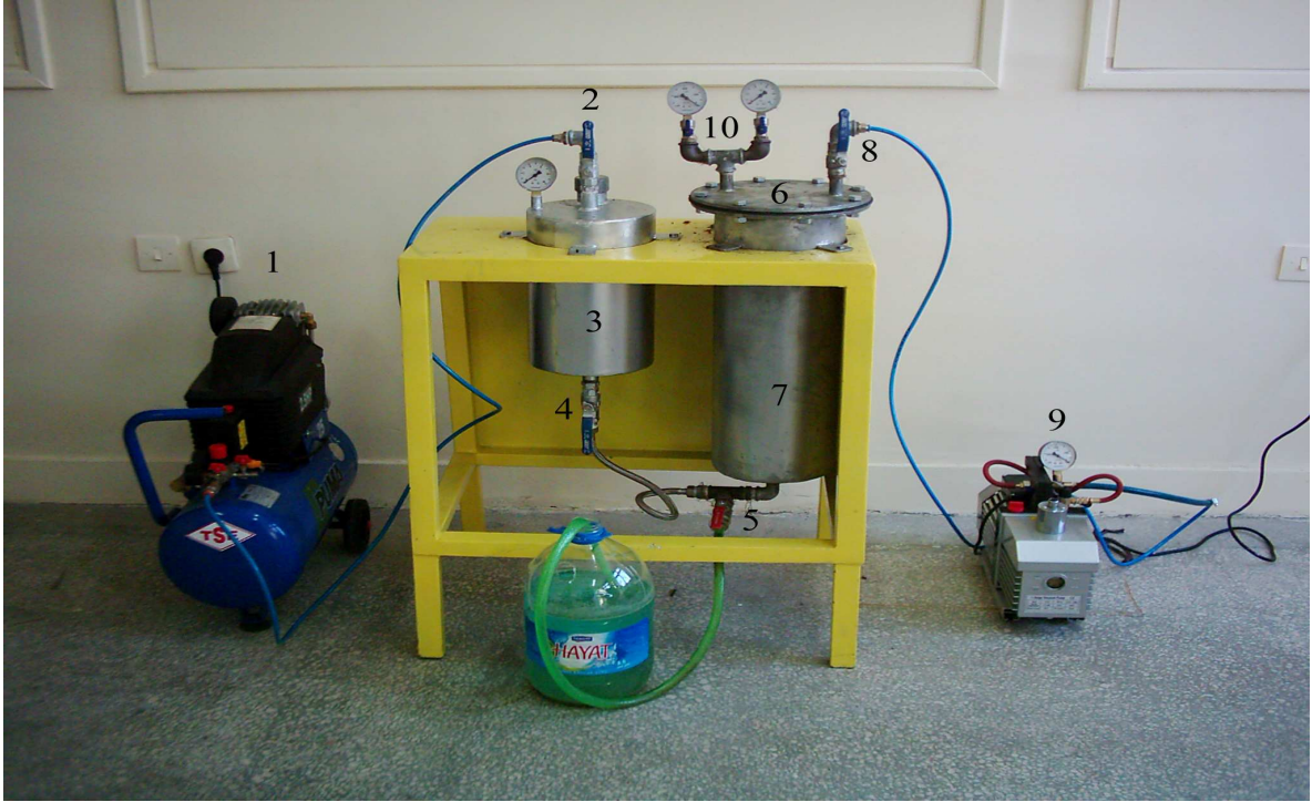
Şekil 3.22. Laboratuvar tipi emprenye kazanı (KSÜ Orman Fakültesi, Odun mekaniği laboratuvarından).(1-Kompresör, 2-Çözelti tankı basınçlı hava giriş vanası, 3-Çözelti tankı, 4-Çözelti boşaltma vanası, 5-Emprenye tankı çözelti çıkış vanası, 6-Emprenye tankı giriş kapağı, 7-Emprenye tankı, 8-Vakum vanası, 9-Vakum pompası, 10-Vakum ve basınç göstergeleri) (Foto BAL).
