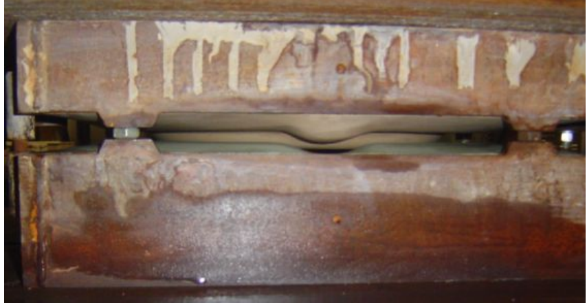
Resim: 92 Alt ve üst kalıpların arasına somunların yerleştirilmesi
