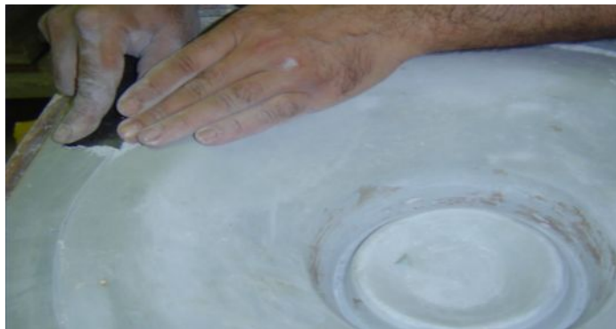
Resim: 32 Çamur tahliye payının açılması
