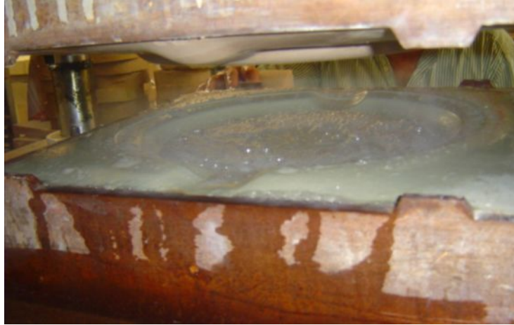
Resim:91 Kalıba hava verilmesi
