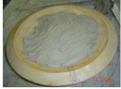
Resim:20 Modele çamur doldurulması
