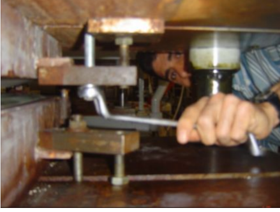
Resim:93 Kalıbın sökülmesi
