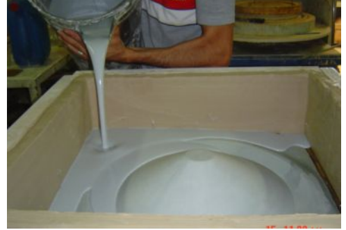
Resim:34 Alçının dökülmesi
