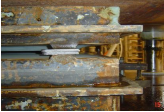
Resim:65 Kalıp aralığının ayarı
