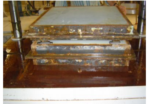
Resim:62 Kalıbın prese bağlanması
