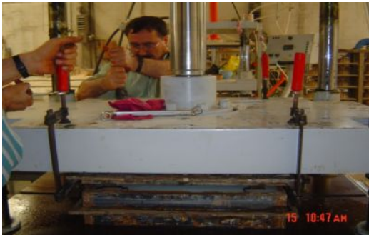
Resim:67 Üst kalıbın mengenelerle sabitlenmesi
