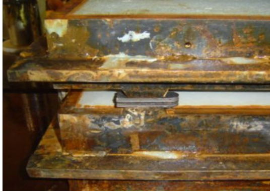
Resim:61 Kalıbın merkezlenmesi
