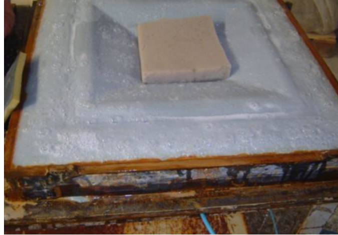
Resim:58 Kalıba hava verilmesi
