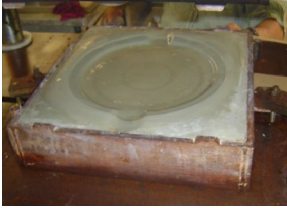
Resim:89 Kalıba su verilmesi
