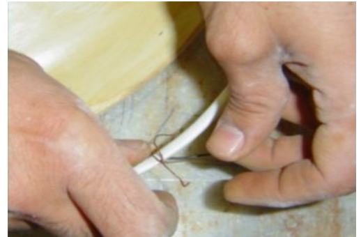
Resim: 16 Hortumun telle bağlanması
