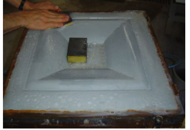
Resim:56 Kalıbın ıslatılması Resim:57 Zımparalama işlemi
