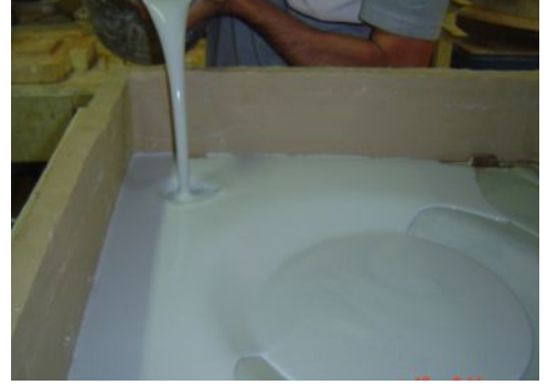
Resim:40 Alçının dökülmesi
