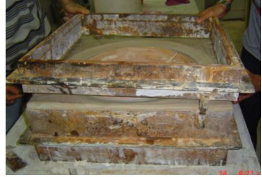
Resim:25 Üst çerçevenin yerleştirilmesi
