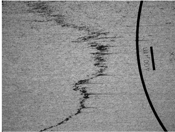
Şekil. 7.5 Dinamik olarak yeniden kristalleşen bölgede deformasyon sonucu meydana gelen ikizleme bandını gösterir yapı fotoğrafı.
