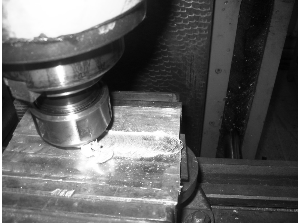
Şekil 6.4 Sürtünme karıştırma kaynağının gösterimi
