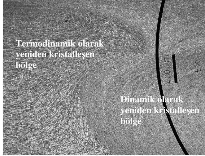
Şekil 7.6 Kaynak sonrası birleşme bölgesinde meydana gelen yapı ve formu
