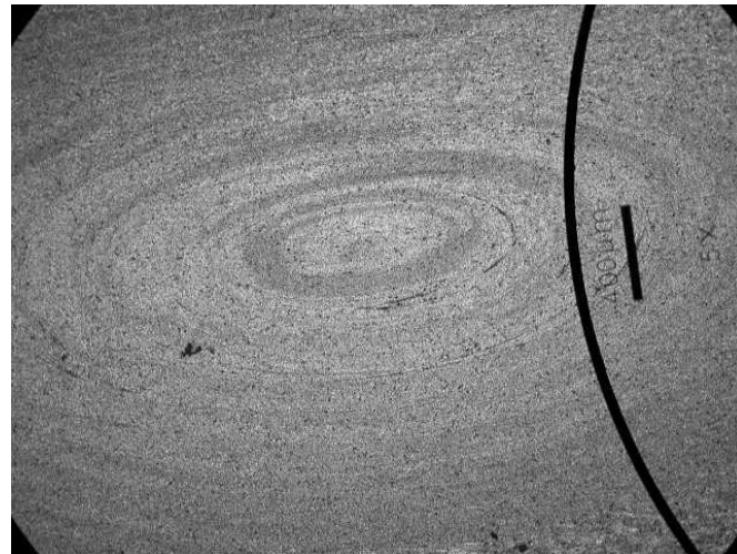
Şekil 7.3 S2 nolu kaynaklı bağlantının birleşme bölgesinde meydana gelen girdap yapısı gösteren mikroyapı fotoğrafı.
