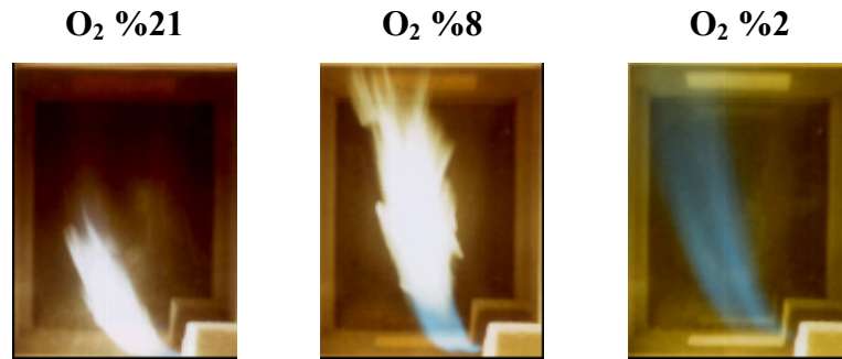
Şekil 4.5. 1100 °C ve çeşitli oksijen konsantrasyonlarındaki yanma görüntüleri
