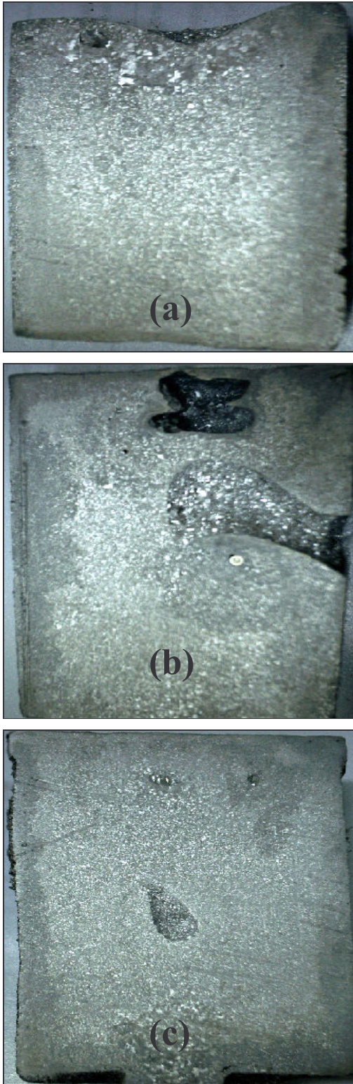
Resim 6.1. Ticari safliktaki ET1AL-3 Al malzemesinin dökülmesi sonucu üretilen numunelerin makroyapı görüntüleri, a) geleneksel döküm, b) 100 mmHg ve c) 500 mmHg vakum ile yerçekimine ters döküm
