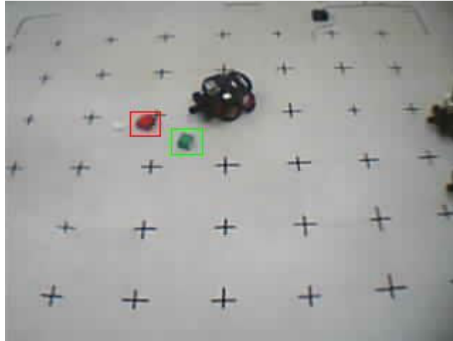
Şekil 3.5 Görüntü Üzerinde Robotun Bulunması
