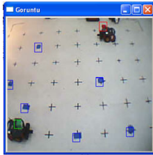
Şekil 3.19. Ortamda Bulunan Gezgin Robotların ve Görev Noktalarının Bulunması
