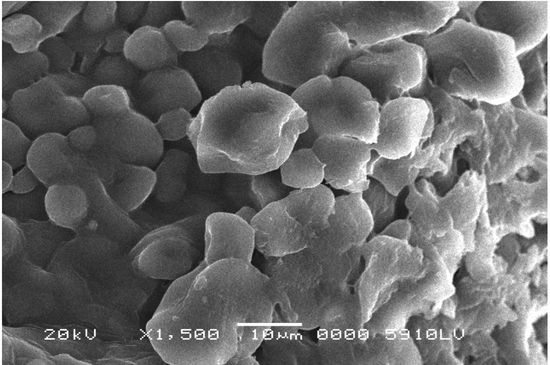
Şekil IV.12. ACVA Başlatıcı Sistemi Kullanılarak Elde Edilen Nişasta-Etilakrilat (1M) Kopolimerinin SEM Fotoğrafi
