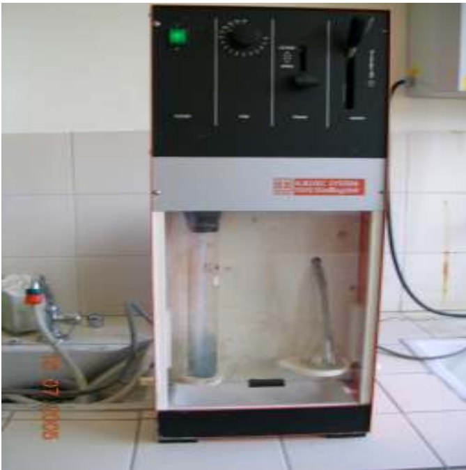
Resim C.2. Kjeldahl Aleti ile Distilasyon İşlemi
