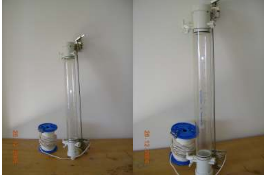
Resim 4.1. Nansen Şişesi (TPN-Su Örnekleme Cihazı HYDRO-BIOS KIEL)
