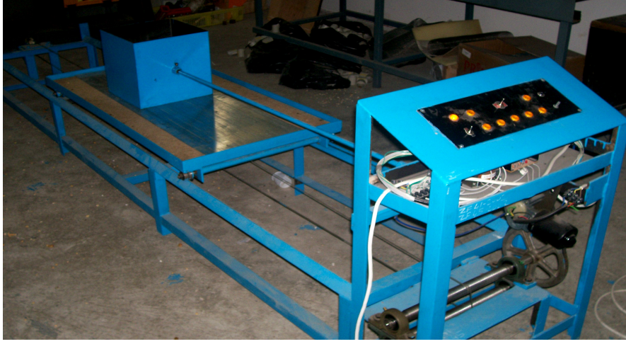
Şekil 3.8. Sürtünme katsayı ölçüm düzeneği
