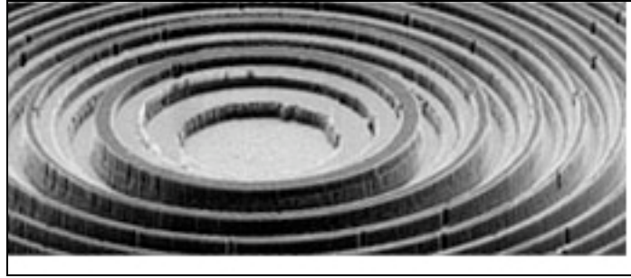
Resim 3.1. Yeni bir teknikle PSI'da üretilen X-ray lens.
