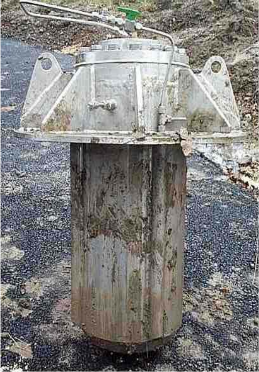
Şekil 1.2: Arazi tipi ıslak hava oksidasyon sistemi
