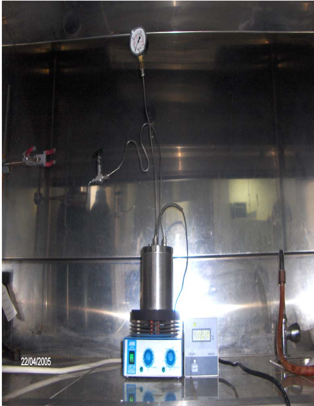
Şekil 3.3. Islak peroksit oksidasyon düzeneği
