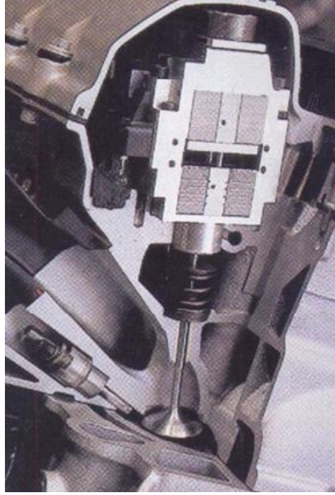
Resim 4.3. Bmw'nin elektromanyetik kontrollü deęişken supap zamanlama mekanizması
