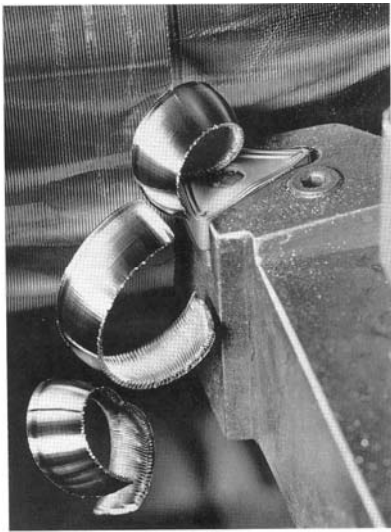
Şekil 3.7. Dalgalı biçime sahip kesici takımla talaş kaldırma [1]
